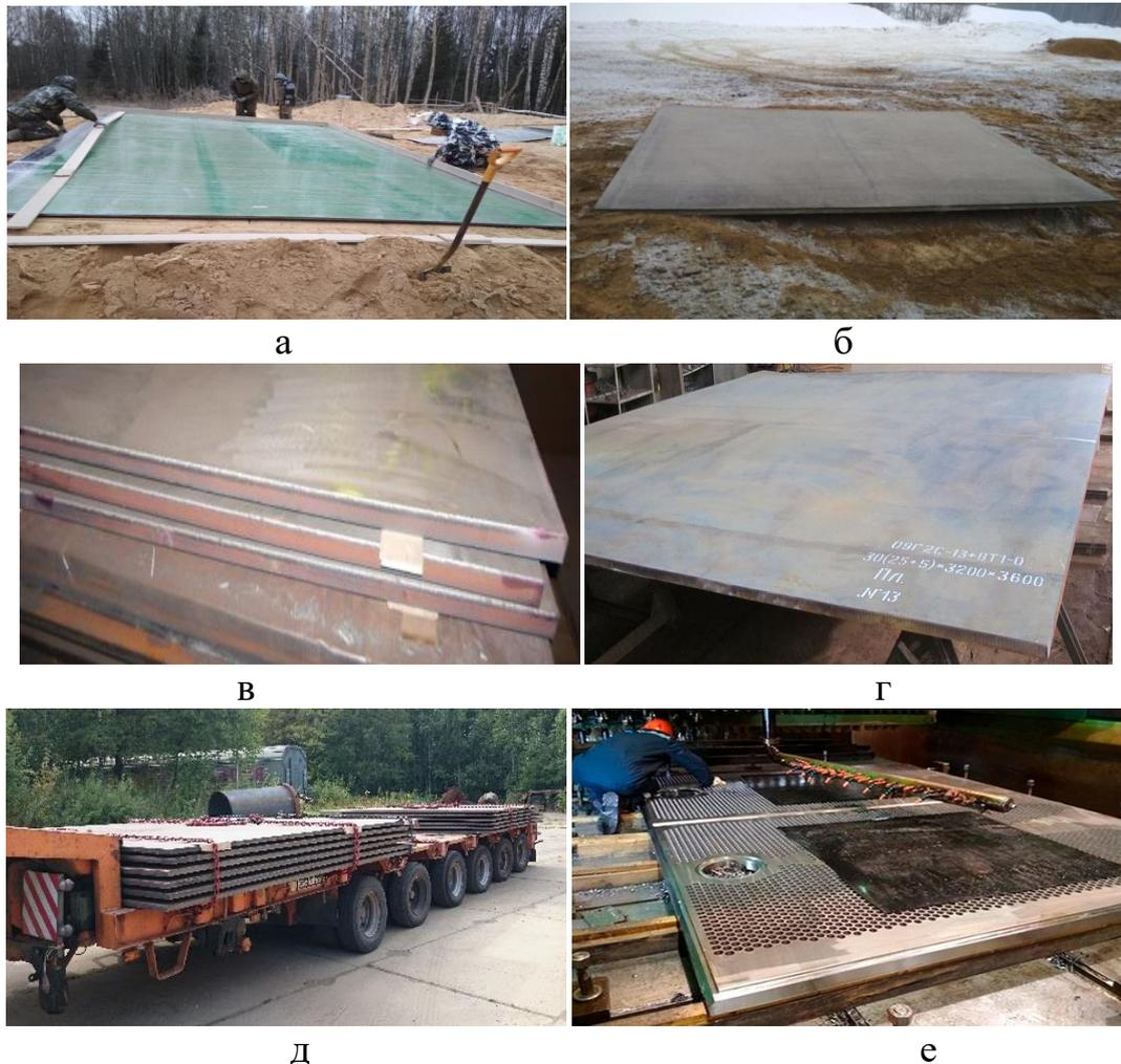
Рисунок 6.19 – Производство крупногабаритных заготовок для трубных досок конденсаторов АЭС из биметалла сталь+титан (09Г2С+ВТ1-0): монтаж опалубки пакета с защитным покрытием (а), лист биметалла сталь+титан после взрыва (б), кромки двуслойного листа после обрезки плазмой (в), лист биметалла сталь+титан после правки (г), отправка партии готового биметалла автотранспортом (д), применение в изделии - трубная доска сталь+титан после сверления отверстий (е).
