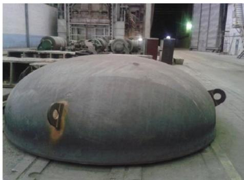
Рисунок 6.13 – Днище ёмкости САОЗ из биметалла 22К+08Х18Н10Т после горячей штамповки.
