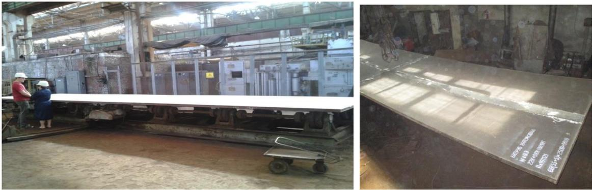
Рисунок 6.16 – Лист двухслойный размерами 60(55+5)x2500x9900 мм после термообработки и правки в АО «Дзержинскхиммаш» (а), готовый к отгрузке лист (б).
