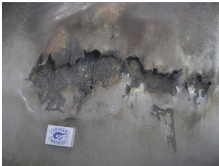
Рисунок 2.16 – Дефект биметалла: прожиг (свищ) поверхности плакирующего слоя.
