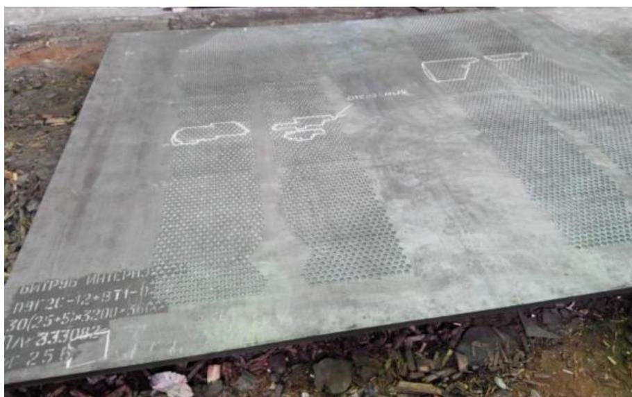
Рисунок 1.11 – Отслоения лакирующего слоя, выявленные в процессе сверления отверстий - участки полупривара (участки пониженной прочности) пары сталь+титан.
