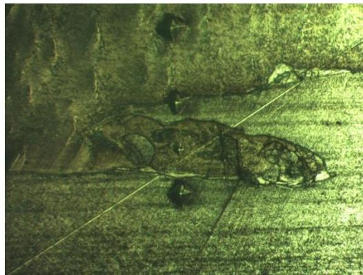
Рисунок 3.23 – Отпечатки микротвердомера в зоне соединения.
