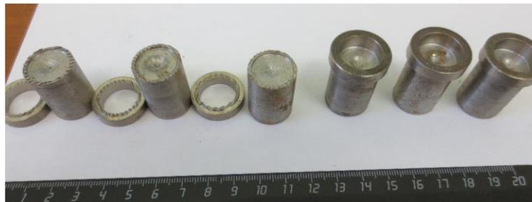
Рисунок 3.19 – Образцы биметалла 09Г2С+ВТ1-0 до и после испытаний прочности соединения слоёв на отрыв.
