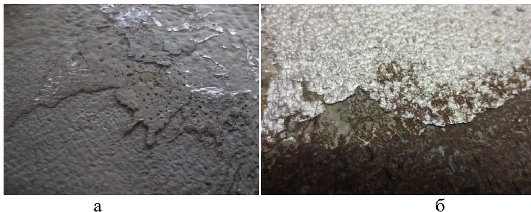
Рисунок 5.14 – Поверхность основного слоя (а) и плакирующего (б) слоев в зоне несплошности после её вскрытия [227].
