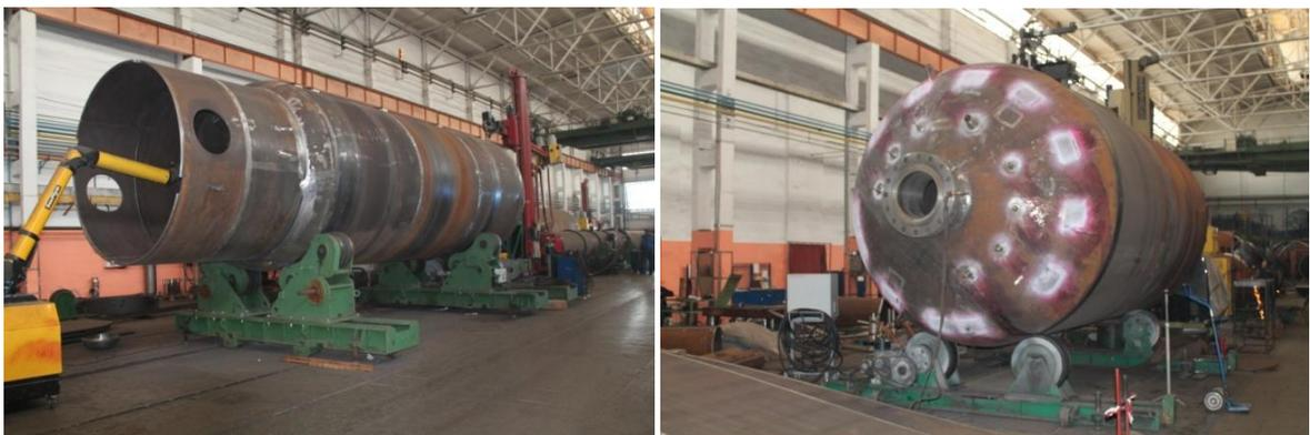
Рисунок 6.17 – Процесс изготовления корпуса САОЗ из биметалла.
