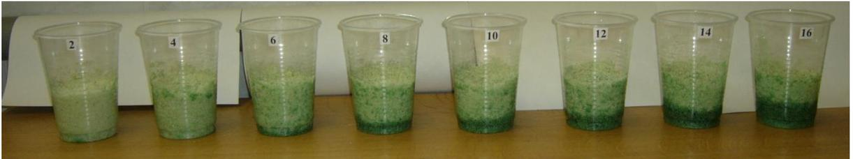
Рисунок 5.4 Гранулированная селитра + дизельное топливо (день 1).
