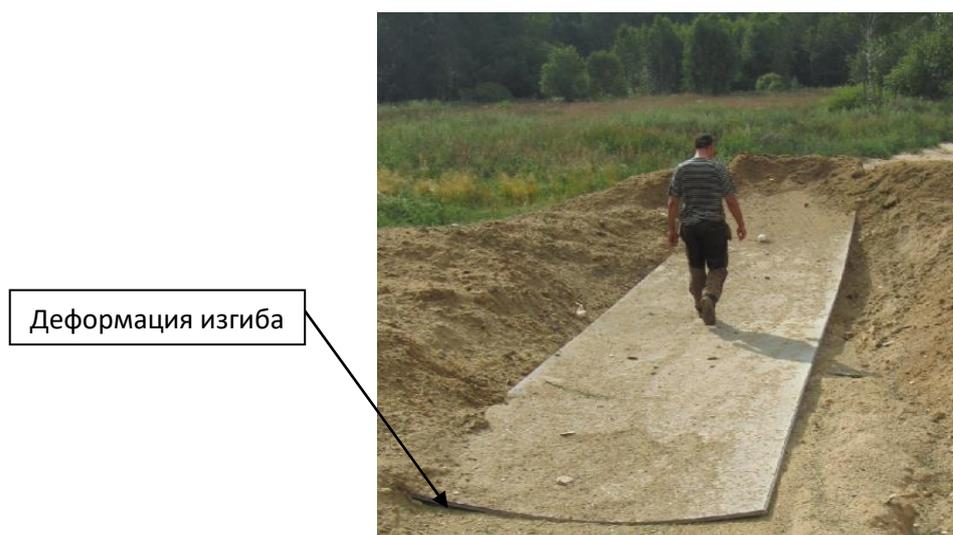
Рисунок 4.12 – Поперечная деформация изгиба биметаллического листа размером 2000x12900 мм после сварки взрывом.
