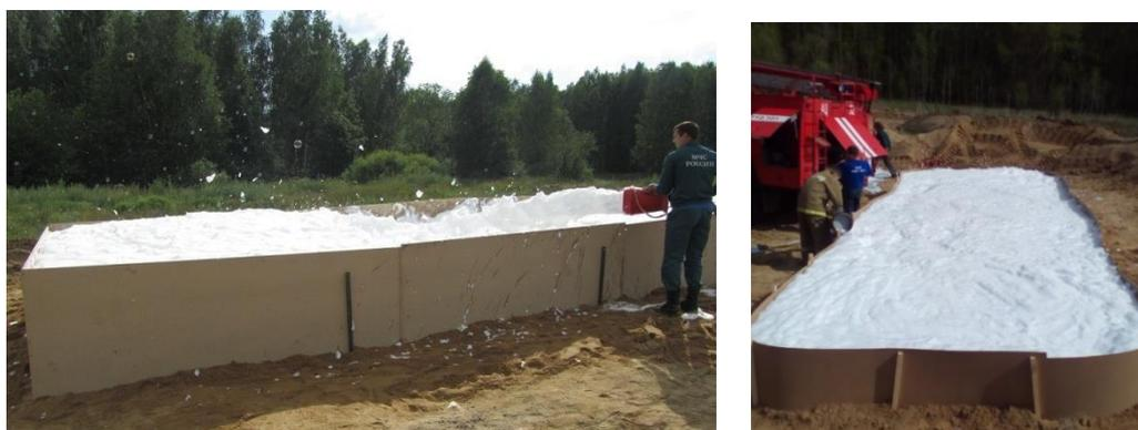
Рисунок 6.11 – Заливка газовоздушной пожарной пены для гашения ударной волны.
