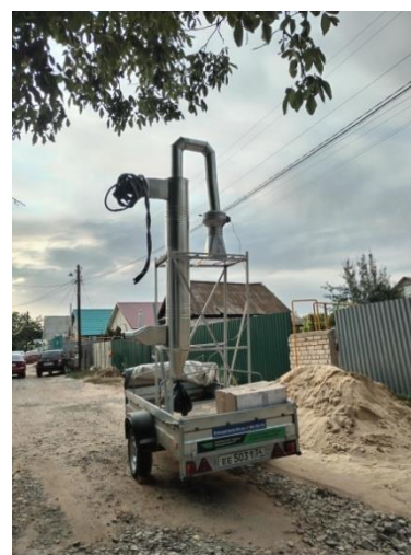
Рисунок 12 – Аспирационная пылеулавливающая установка (патент РФ 2788387):
