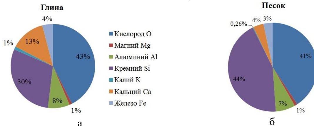
Рисунок 7 – Результаты анализа химического состава образцов: а – песка; б - глины
