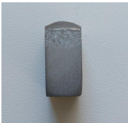
Рисунок 4.49 – Поперечное сечение валика, наплавленного с применением медных формирующих пластин
