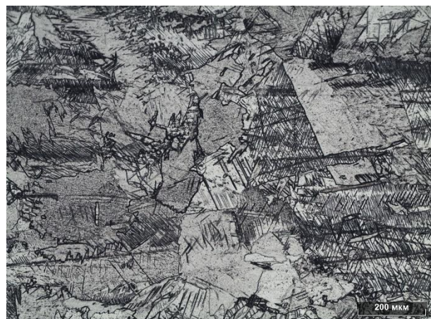
Рисунок 3.26 – Микроструктура титана ВТ1-0, не подвергавшегося термическому воздействию
