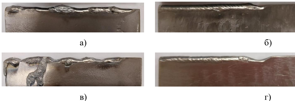
Рисунок 4.50 – Наплавка торцевых поверхностей деталей из титана ВТ1-0 ( s=10 мм),
