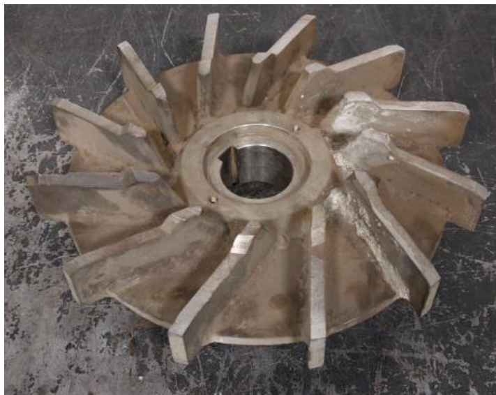
Рисунок 4.47 – Рабочее колесо насоса 1X-80-50-200А-ТЛ-55 из титанового сплава BT1-0
