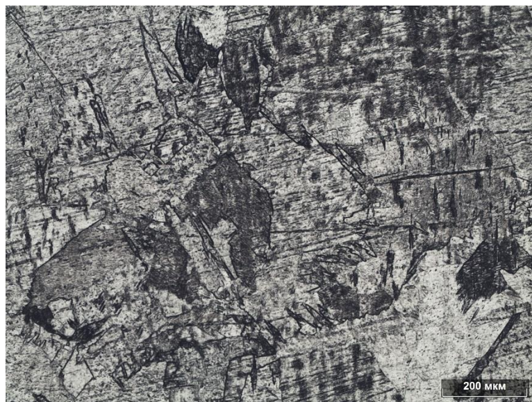
Рисунок 3.51 – Микроструктура ЗТВ в после наплавки ( I_n = 270 А, V_n = 0,15 м/мин, V_{п/п} Al = 2 м/мин; предварительный подогрев 400 °С)
