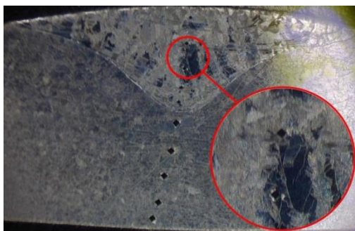
Рисунок 3.28 – Схема измерения твердости при исследовании зоны термического влияния
