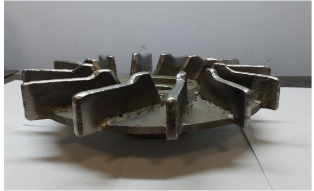
Рисунок 4.51 – Внешний вид наплавленного рабочего колеса насоса 1Х-80-50-200А-ТЛ-55
