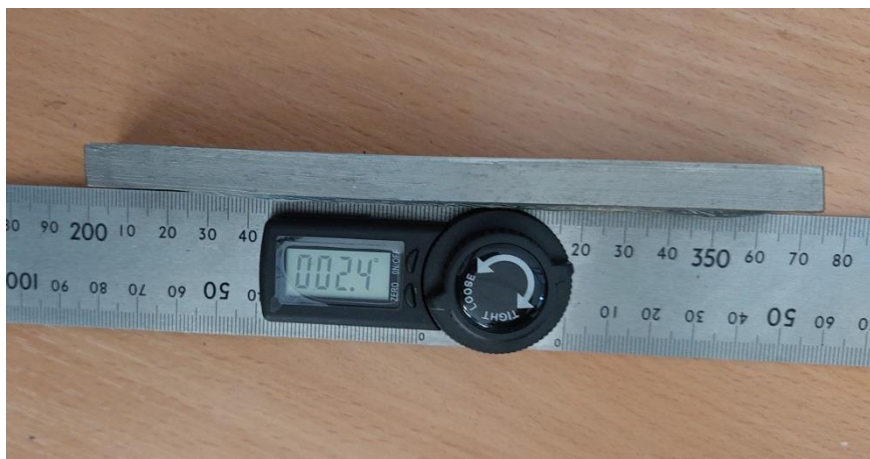
Рисунок 3.41 – Угол изгиба наплавленного образца системы Ti-Al на основе фазы \gamma(\text{TiAl}) при появлении первой трещины
