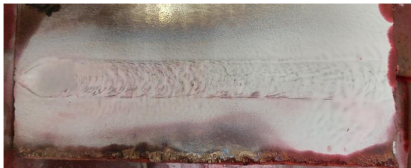
Рисунок 4.27 – Внешний вид наплавленного валика при режимах I_{\text{н}} = 270 \text{ А} , V_{\text{н}} = 0,15 \text{ м/мин} , V_{\text{п/п Al}} = 1 \text{ м/мин} , T_{\text{под}} = 200^\circ\text{С}
