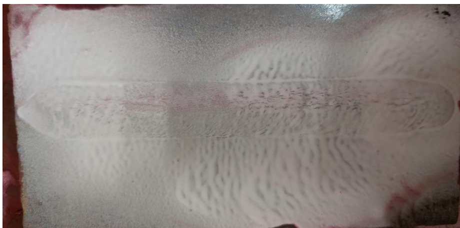
Рисунок 4.28 – Внешний вид наплавленного валика при режимах I_n = 270 А, V_n = 0,15 м/мин, V_{п/п} Al = 2 м/мин, T_{под} = 200^\circ\text{C}
