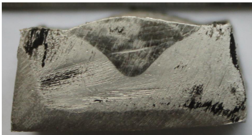
Рисунок 4.36 – Поперечное сечение наплавленного валика
