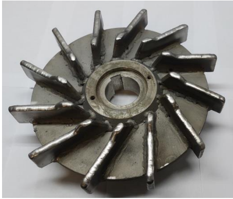
Рисунок 4.51 – Внешний вид наплавленного рабочего колеса насоса 1Х-80-50-200А-ТЛ-55
