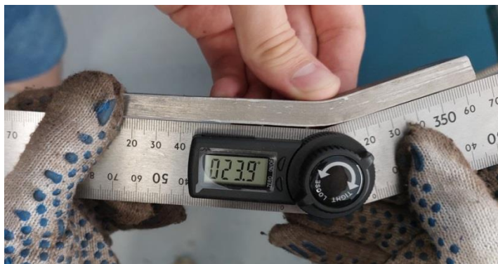
Рисунок 3.38 – Угол изгиба наплавленного образца системы Ti-Al на основе фаз \alpha (Ti) + \alpha_2 (Ti 3 Al) при появлении первой трещины
