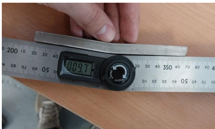
Рисунок 3.39 – Угол изгиба наплавленного образца системы Ti-Al на основе фазы \alpha_2 (Ti 3 Al) при появлении первой трещины
