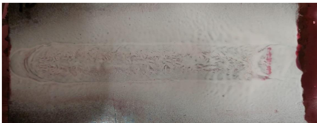
Рисунок 4.29 – Внешний вид наплавленного валика при режимах I_n = 270 А, V_n = 0,15 м/мин, V_{п/п} Al = 3 м/мин, T_{под} = 200^\circ\text{C}
