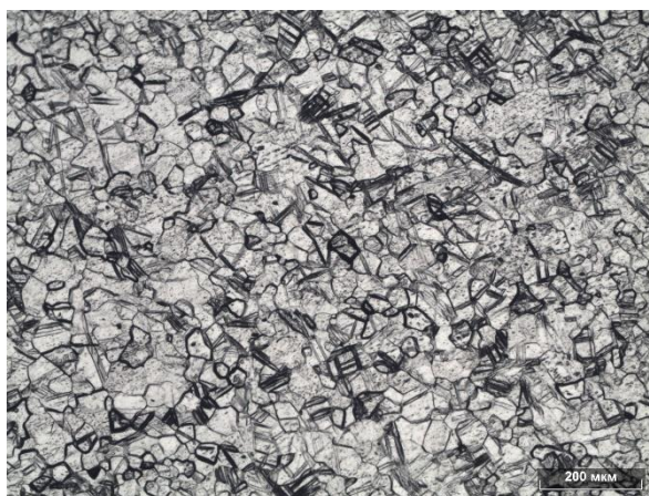
Рисунок 3.26 – Микроструктура титана ВТ1-0, не подвергавшегося термическому воздействию
