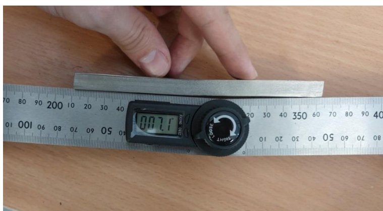
Рисунок 3.40 – Угол изгиба наплавленного образца системы Ti-Al на основе фаз \alpha_2 (Ti 3 Al) + \gamma (TiAl) при появлении первой трещины
