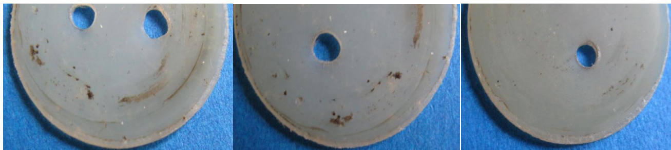
Рисунок 2 – Фотографии после трения образцов исходного полиакриламида (а), содержащего \text{HCF}_2\text{CF}_2\text{CH}_2\text{OH} в количествах 0,05 % масс. (б) и 0,005 % масс. (в) [138]
