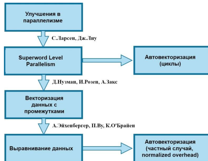
Рисунок 2.8 - Методы, используемые при построении блоков автоматической векторизации
