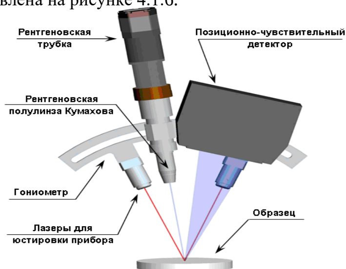
Рисунок 4.1.6 – Принципиальная схема устройства рентгеновского измерительного комплекса
