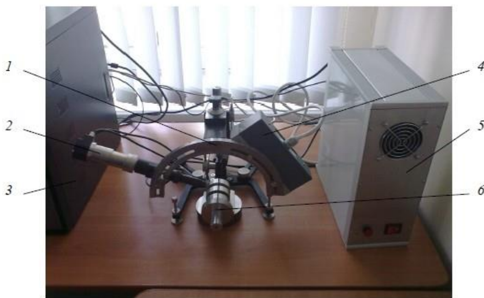
Рисунок 4.1.4. – Конструкция рентгеновского измерительного комплекса «Рикор-7»
