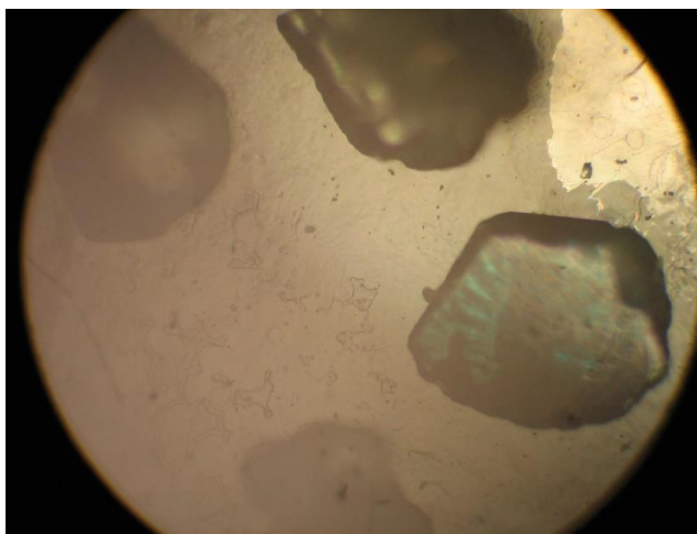
Рис. 2.2.2 – Фотографии абразивных зерен
