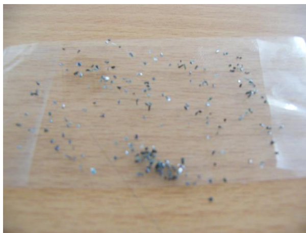
Рис. 3.1.4 – Образец, изготовленный насыпкой навески абразивных зерен на скотч
