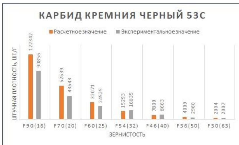
Рис.3.2.7 – Графическая зависимость штучной плотности от зернистости карбида кремния 53С
