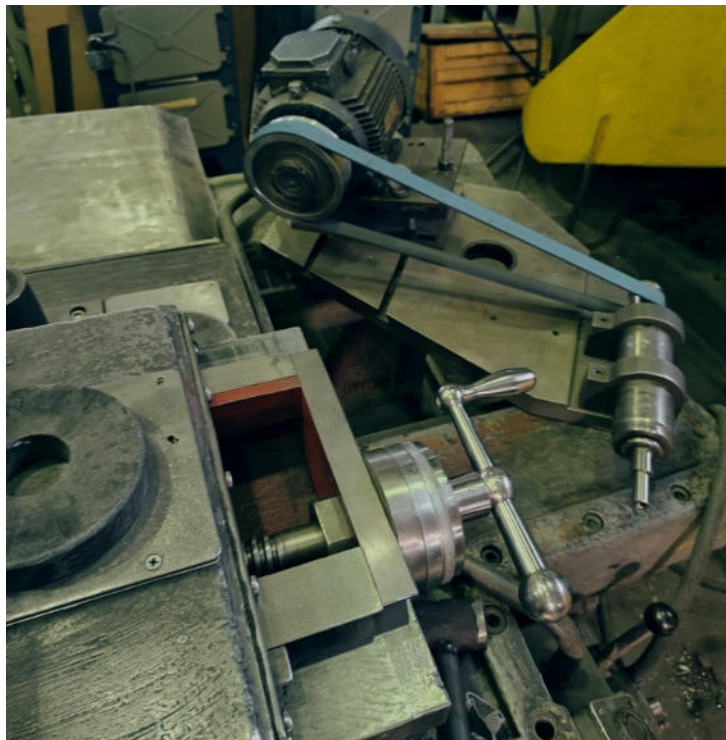
Рисунок 1.7 Сменный привод для шлифовальных кругов, который устанавливается на суппорт токарно-лобового станка
