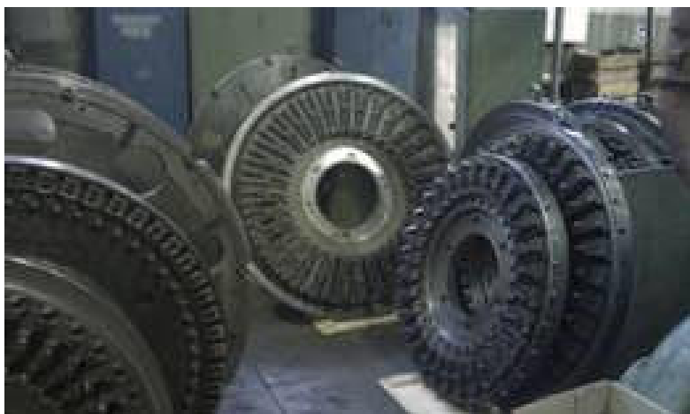
Рисунок 1.6 Роторное приспособление для установки лопаток [73]
