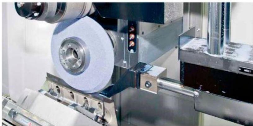
Рисунок 3.4 Процесс обработки цилиндрической поверхности детали
