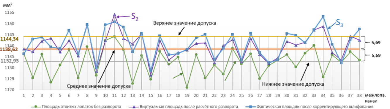
Рисунок 4.4 Распределение площади проходного сечения единичного межлопаточного канала S , \text{мм}^2 : площадь литых лопаток без разворота S_1 , виртуально рассчитанная площадь S_2 с углом разворота, фактически полученная площадь S_3 после корректирующей обработки на станке с ЧПУ
