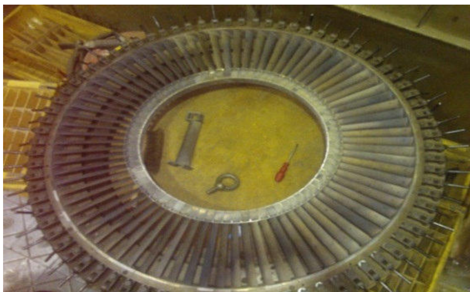
Рисунок 1.8 Роторное приспособление для установки сопловых лопаток [73]
