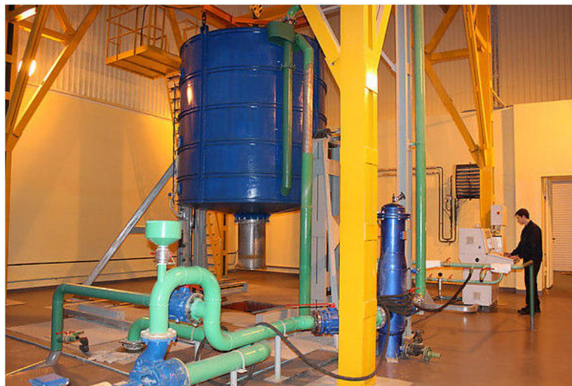
Рисунок 1.20 Испытательный стенд для определения пропускной способности сопловых аппаратов вертолетного двигателя типа ВК-2500 [116]
