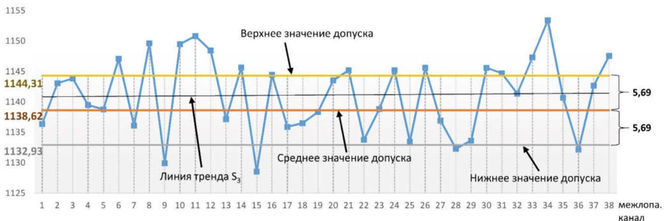
Рисунок 4.3 Распределение площади проходного сечения единичного межлопаточного канала, которая фактически получилась после корректирующей обработки на станке с ЧПУ (указаны данные для одного комплекта лопаток)
