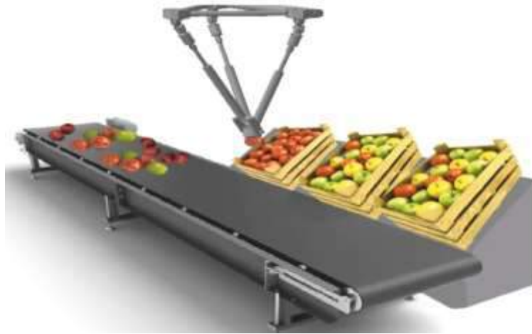
Рисунок 2.9 – Манипуляционный робот для сортировки плодов овощей, фруктов
