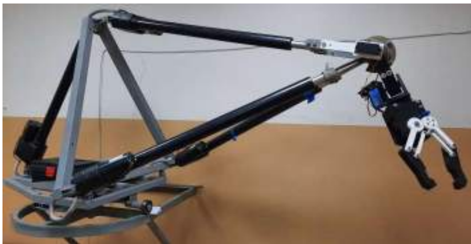
Рисунок 3.2 – Манипулятор-трипод с антропоморфным захватным устройством с тремя степенями свободы
