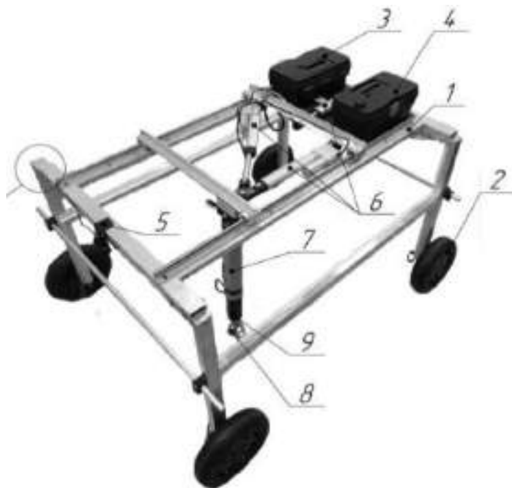
Рисунок 6.25 – Опытный образец робота-пропольщика для механического удаления сорняков
