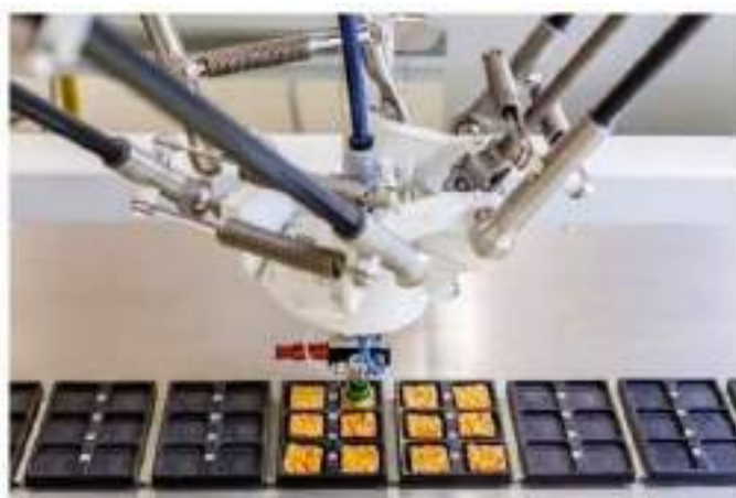
Рисунок 1.4 – Дельта робот-манипулятор компании Fanuc
