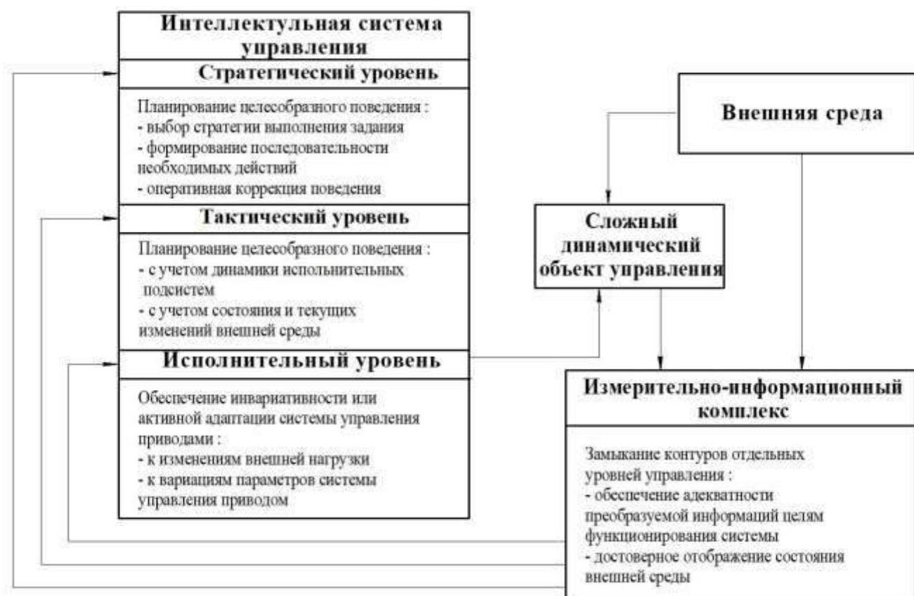
Рисунок 1.17 – Иерархическое построение интеллектуальной системы управления сложным динамическим объектом
