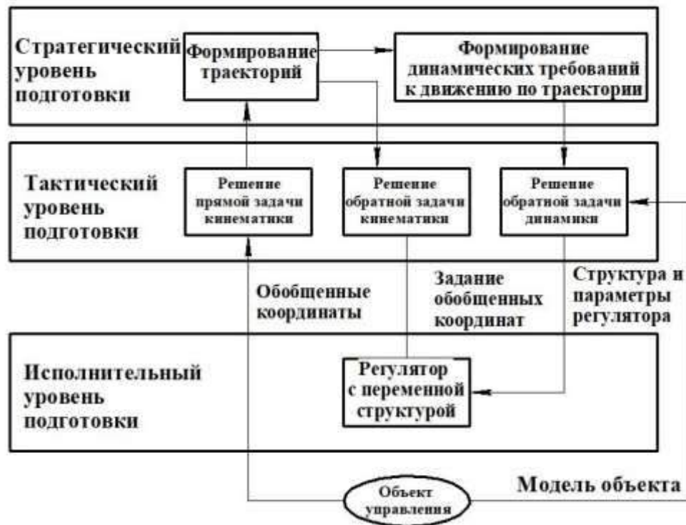
Рисунок 1.15 – Схема иерархической системы, осуществляющей управление сложным динамическим объектом
