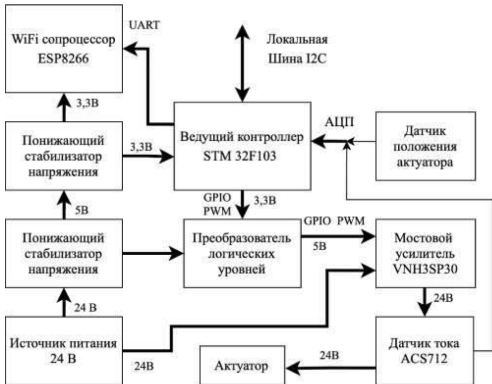
Рисунок 6.11 – Структурная схема модуля управления актуатором
