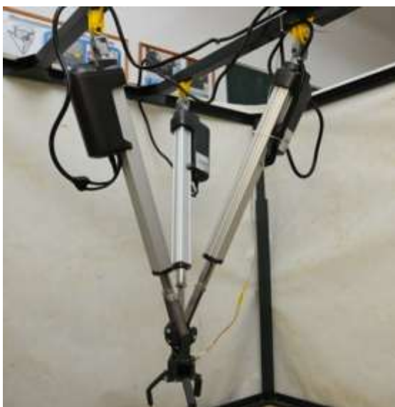
Рисунок 6.28 – Опытный образец манипулятора-трипода с управляемым захватом
