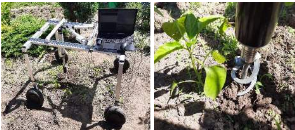
Рисунок 6.27 – Экспериментальные испытания робота-пропольщика
