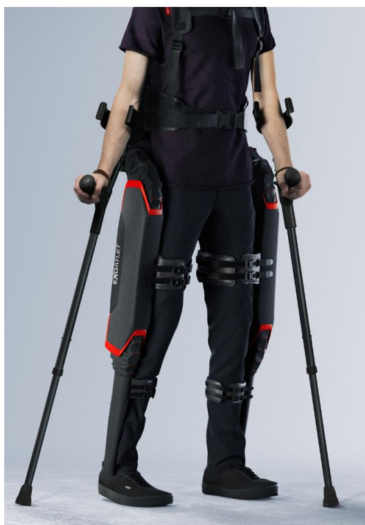
Рисунок 6 –Экзоскелет ExoAtlet на операторе
