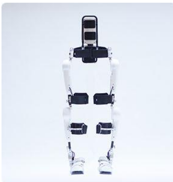
Рисунок 9 – Экзоскелет HAL на операторе
