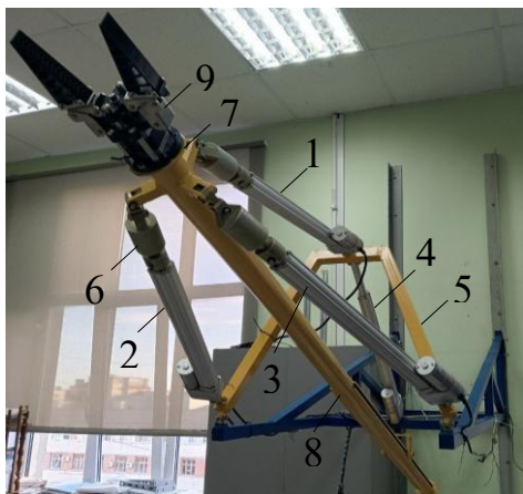
Рис. 5. Экспериментальный образец манипулятора параллельно-последовательной структуры с дополнительной связью и однопроцессорная система управления манипулятором: 1-4 – исполнительные приводы; 5 – поворотное основание; 6 – трехстепенные шарниры; 7 – выходное звено; 8 – металлическая труба; 9 – захватное устройство.
