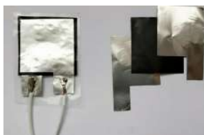
б) Простейший преобразователь силы на основе Velostat
