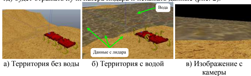
Рис. 2 — Примеры ситуаций, где навигация, основанная на камере или лидаре построит неправильную карту
