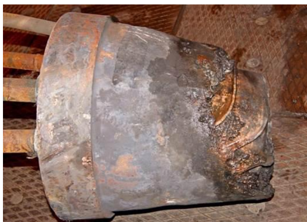
Рис. 6.10. Разрушение медной поверхности фурмы при прогаре
