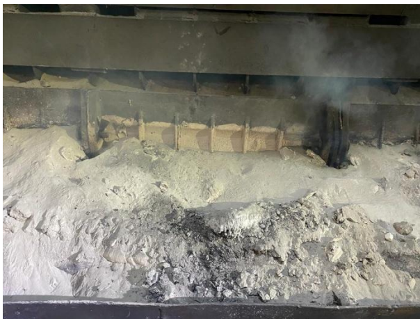
Рис. 6.1. Электролизер Содерберга ( a ), внешний вид секции ГСК в рабочем состоянии ( б ) и после прогара ( в )
