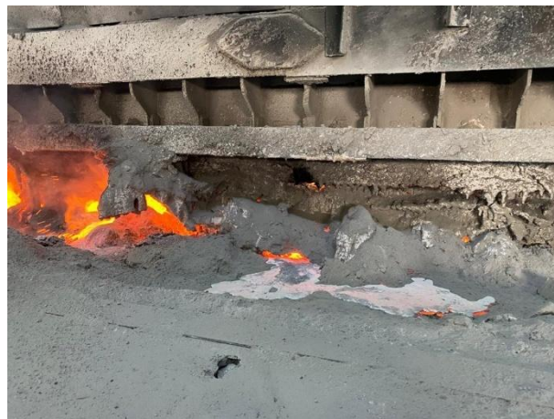
Рис. 6.1. Электролизер Содерберга ( a ), внешний вид секции ГСК в рабочем состоянии ( б ) и после прогара ( в )
