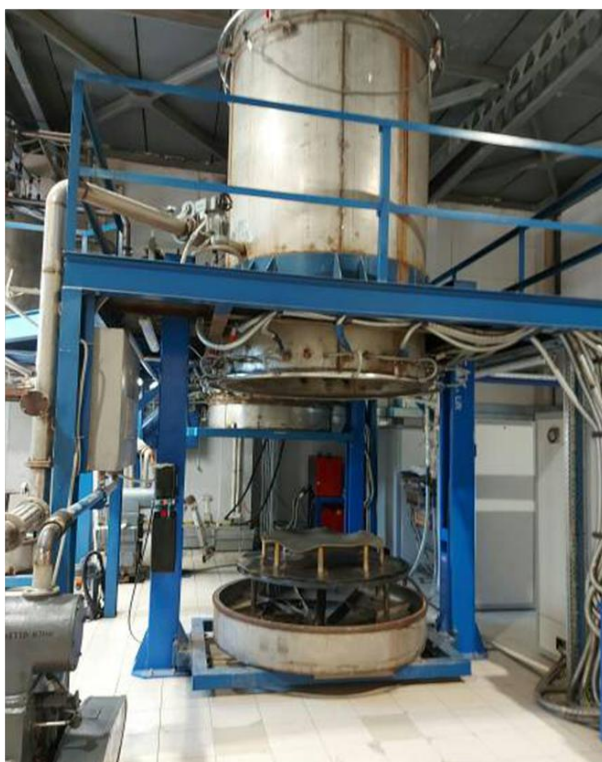
Рис. 6.7. Внешний вид промышленной вакуумной печи, используемой на ООО «НПО «СПЛАВ-Ти» (а), и внутренний вид ее колпака с нагревательными элементами (б)
