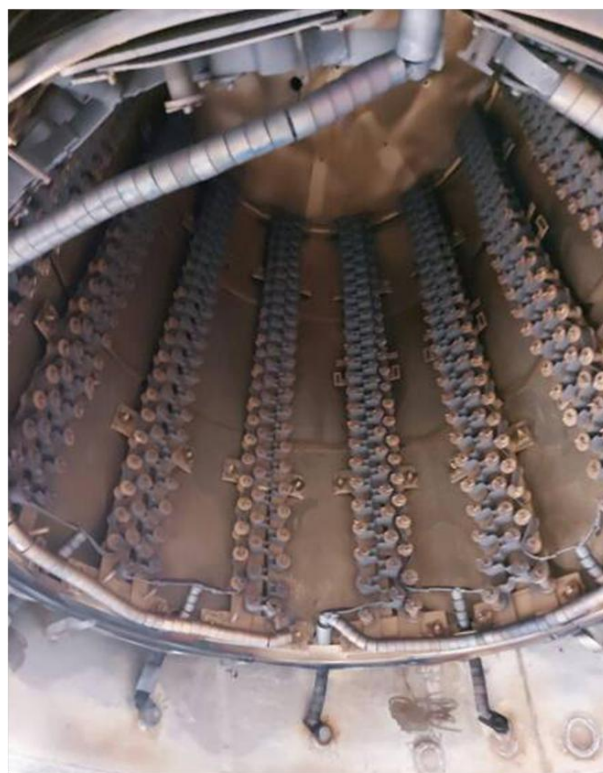
Рис. 6.7. Внешний вид промышленной вакуумной печи, используемой на ООО «НПО «СПЛАВ-Ти» (а), и внутренний вид ее колпака с нагревательными элементами (б)
