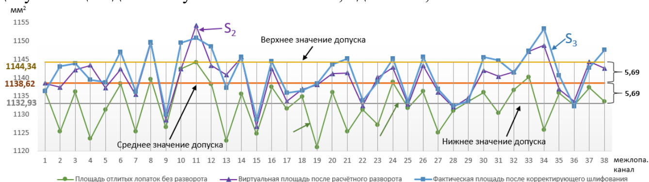
Рисунок 8 Распределение площади проходного сечения единичного межлопаточного канала в виртуально собранном сопловом аппарате: S_1 – площадь литых лопаток без разворота, S_2 – виртуально рассчитанная площадь с учётом угла разворота, S_3 – фактическая площадь, полученная после корректирующей обработки на станке с ЧПУ
