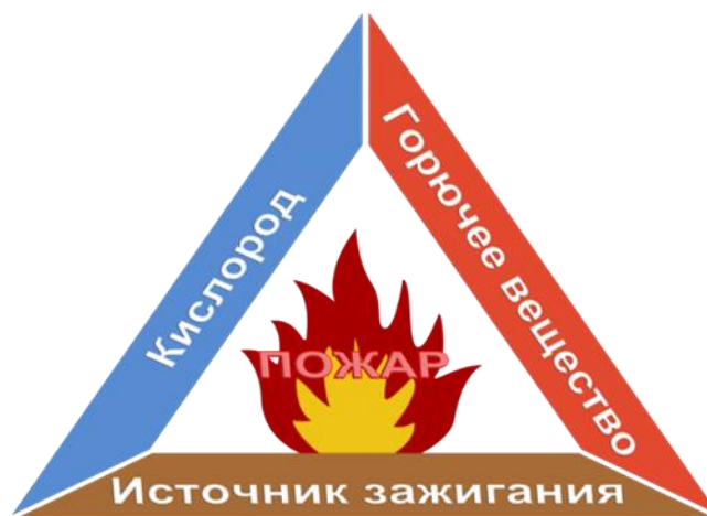
Рисунок 1.2 – Принцип треугольника горения и цикла горения полимеров
