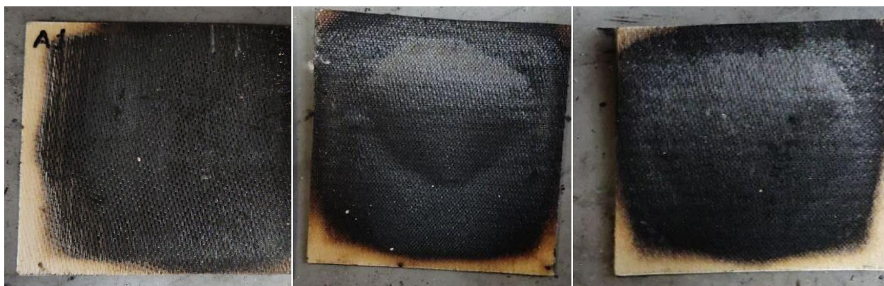
Рисунок 3.24 – Фотографии образцов после испытаний на тепловыделение.
