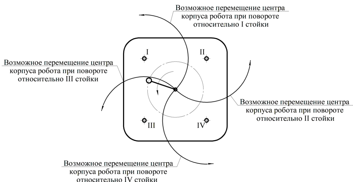
Рисунок 2.2 – Возможные перемещения центра масс корпуса мобильного робота при повороте относительно разных стоек
