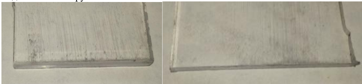
Рис. 6 – Образцы с рисками: а) полученными неизношенным магнитно-абразивным порошком; б) полученными после 30 минут работы магнитно-абразивного порошка
