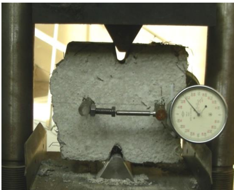
Рисунок 2.17 – Испытания образца на центральное растяжение методом расклинивания
