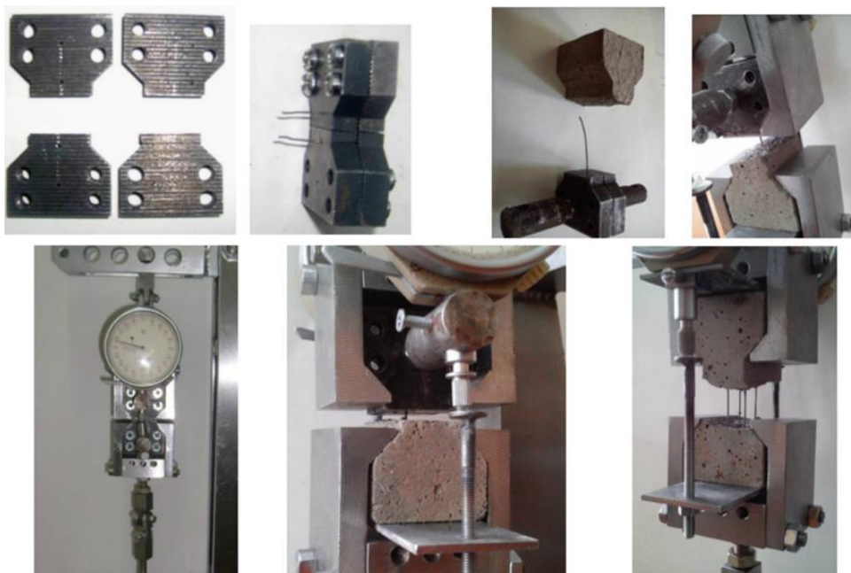
Рисунок 2.4 – Использование зажимов для испытания фибры
