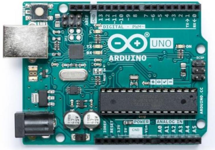
Рисунок 4.3 - Внешний вид платы ARDUINO UNO R3.
