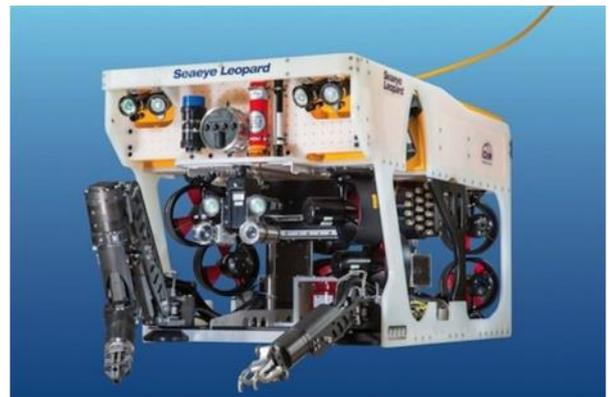
Рисунок 1.17 – Многоприводные винтовые движители подводных роботов.
