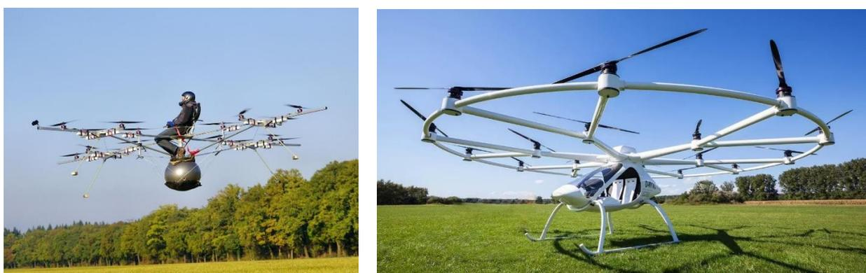
Рисунок 1.2 – Мультикоптеры с распределенной электрической тягой (DEP).
