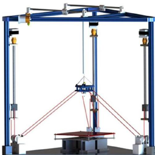
Рисунок 1.15 – Кабельный робот параллельной структуры для 3D печати.
