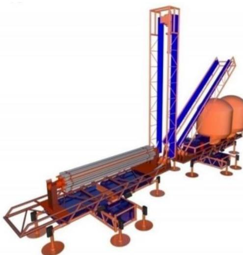
Рисунок 1.20 – Концепция применения нескольких роботизированных шагающих платформ для осуществления совместной полезной работы на морском грунте [58].
