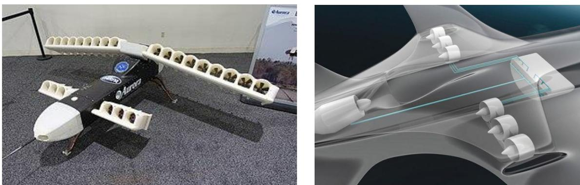
Рисунок 1.1 – БПЛА с распределенной силовой установкой (DP).
