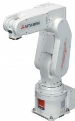
Рисунок 1.4 – Робот промышленный Mitsubishi RV-2SDB
