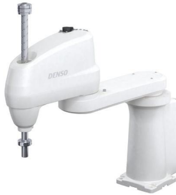
Рисунок 1.3 – SCARA манипулятор Denso HS-4555G
