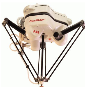
Рисунок 1.6 – Дельта-робот компании ABB IRB Flex Picker
