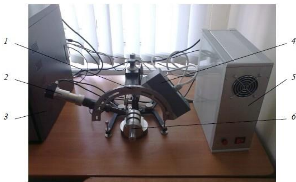
Рисунок 4.1.2. – Конструкция рентгеновского измерительного комплекса «Рикор-7»
