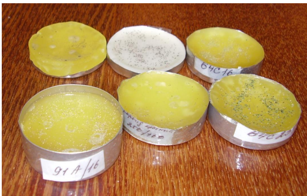
Рис.3.1.3 – Образцы, изготовленные насыпкой абразивного материала на расплавленное связующее
