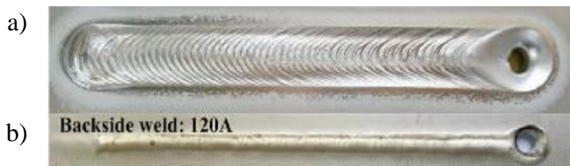
Рисунок 1.6 – Влияние импульсного базового тока на формирование сварного шва [29]: вид проплавления с внешней (а) и обратной стороны (b)
