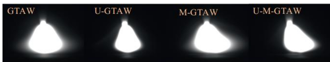
Рисунок 1.24 – Форма дуги при различных методах сварки [67]:
