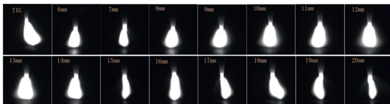
Рисунок 1.23 - Форма дуги при различной высоте излучателя [67]
