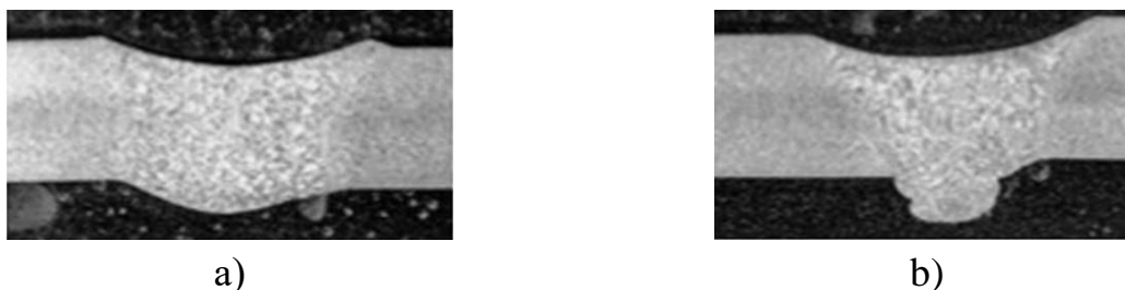
Рисунок 1.1 – Макрошлифы сварных соединений алюминиевого сплава АМг-5: а) без флюса; б) с флюсом \text{CaF}_2\text{-BaF}_2\text{-SrF}_2 ( I_{\text{св.}}=210 А, V_{\text{св.}}=54 см/мин, S=4 мм) [16]
