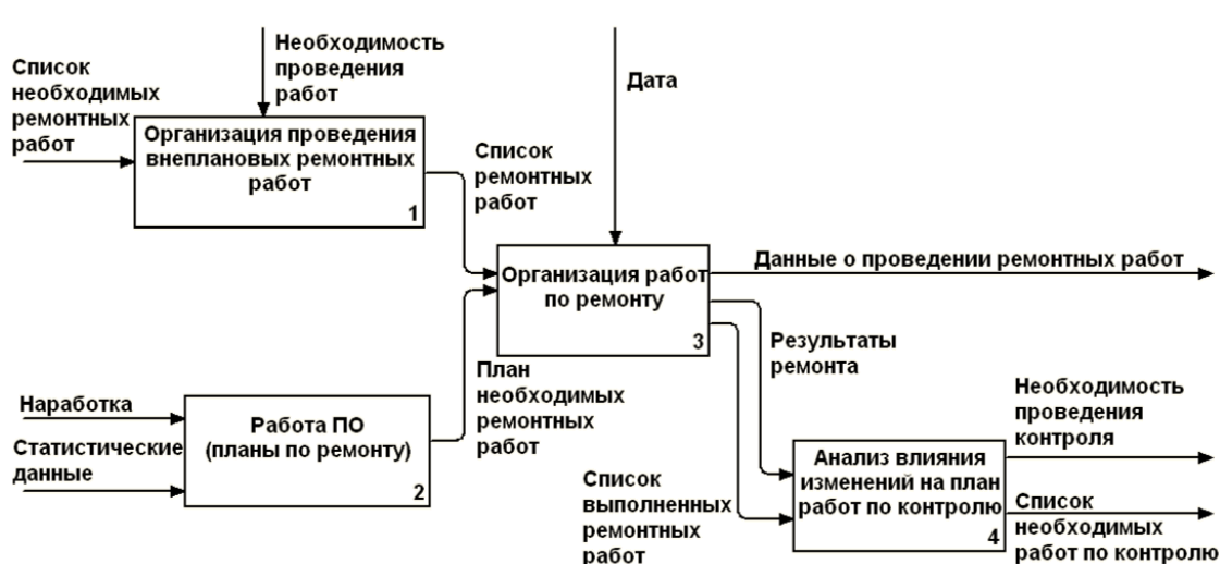
Рисунок 56 – Схема процесса «Выполнение работ по ремонту оборудования».
