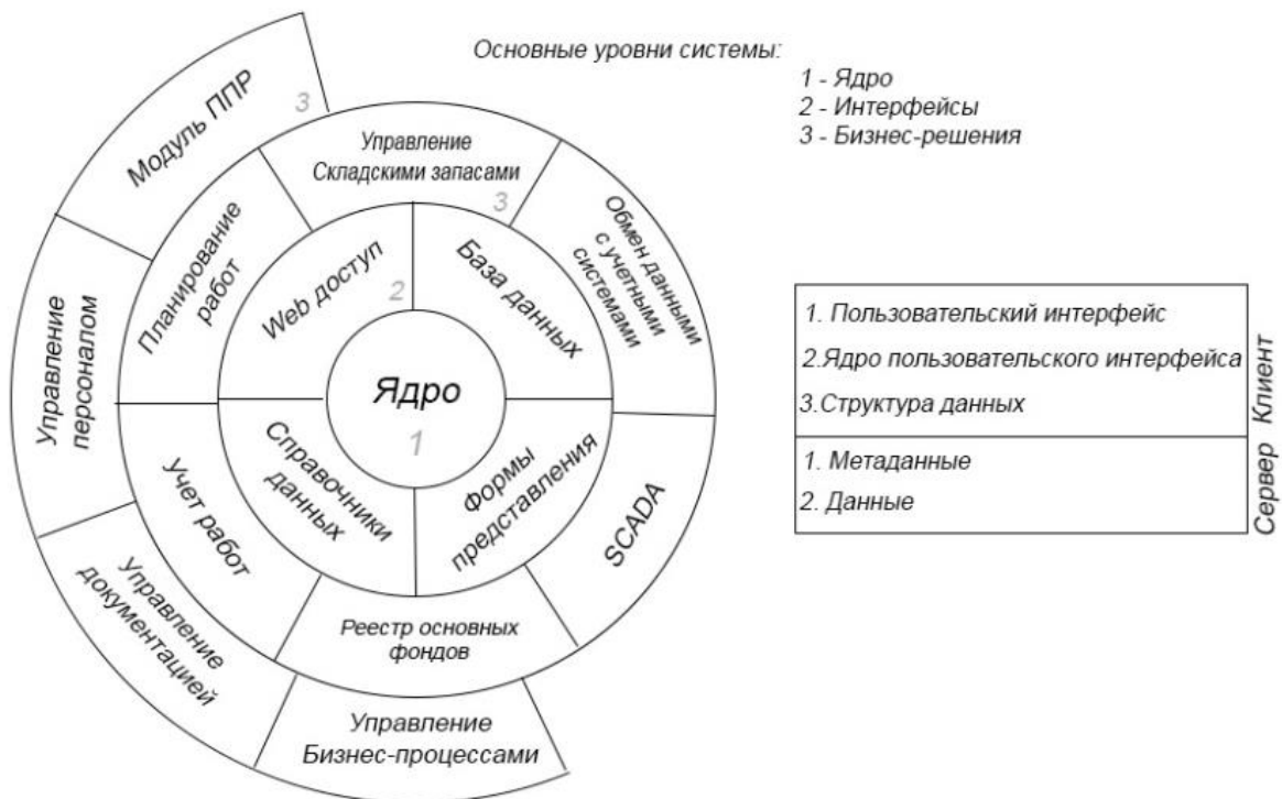
Рисунок 54 – Архитектура платформы быстрой разработки программных систем поддержки ТОиР оборудования.
