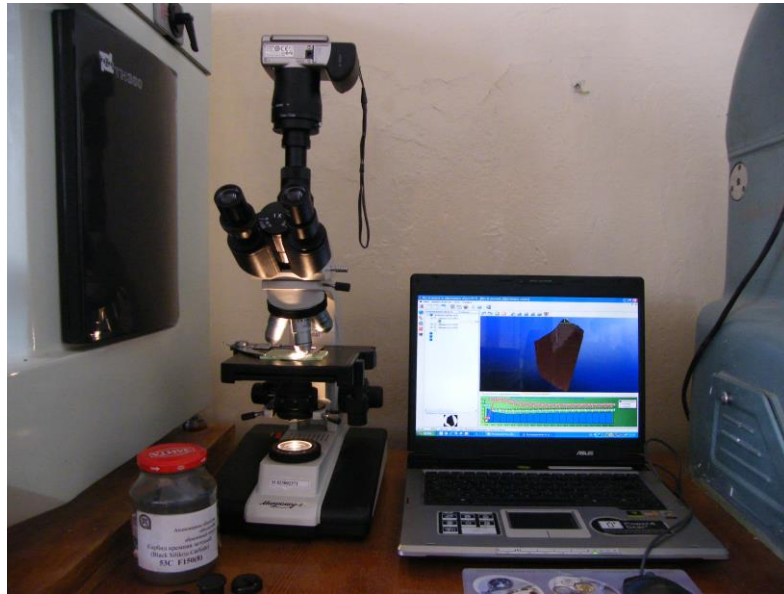
Рис. 2.2.1 – Общий вид экспериментальной установки на основе микроскопа Микромед-2
