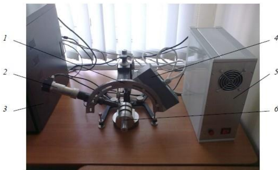
Рисунок 4.1.4. – Конструкция рентгеновского измерительного комплекса «Рикор-7»
