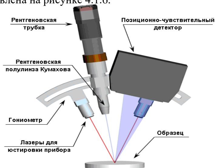
Рисунок 4.1.6 – Принципиальная схема устройства рентгеновского измерительного комплекса
