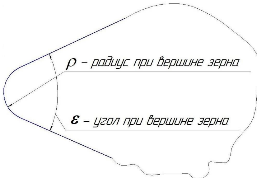
Рис. 2.1.1 – Традиционная модель режущей кромки а.з. по Маслову Е.Н., Лурье Г.Б. и Рыбакову В.А.
