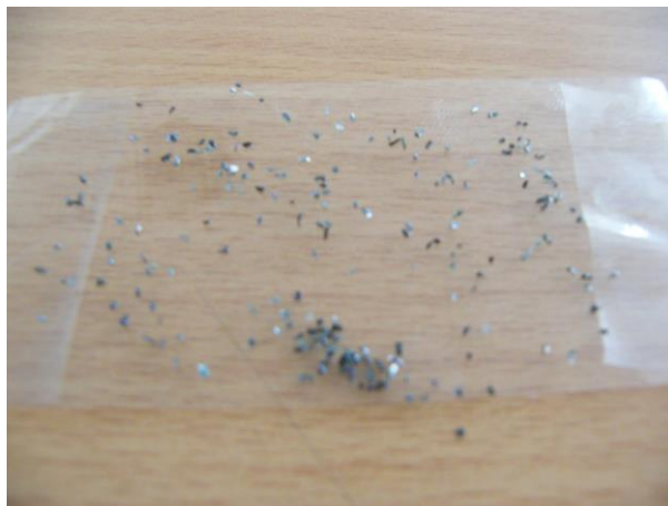
Рис. 3.1.4 – Образец, изготовленный насыпкой навески абразивных зерен на скотч
