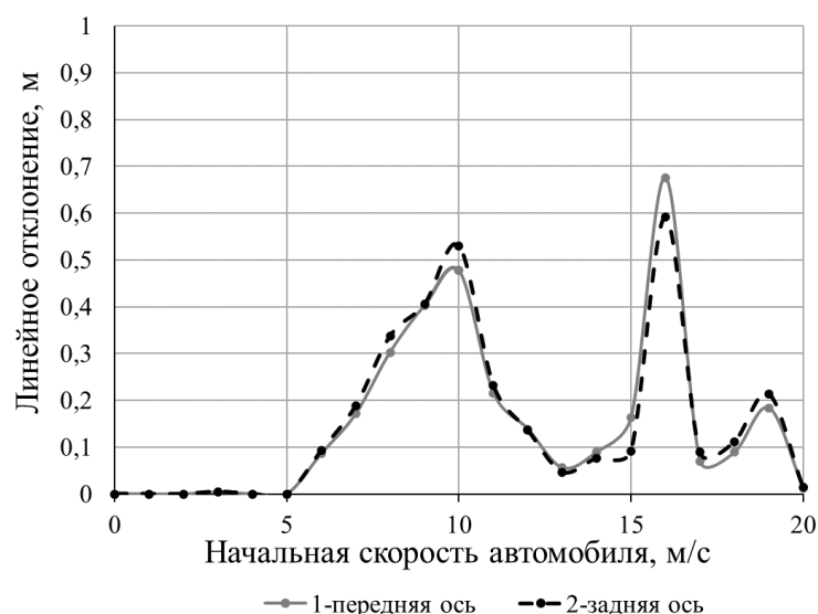
Рисунок 10 – Абсолютное изменение расчетных линейных отклонений автомобиля – объекта исследования – при учете сносов реакций опорной поверхности (маневр «торможение в повороте»)
