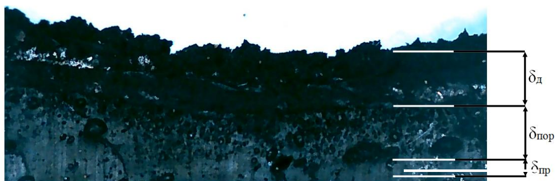
Рисунок 6.16 – Микрофотография среза образца, содержащего микросферы, после высокотемпературного испытания (кратность увеличения \times 100 )
