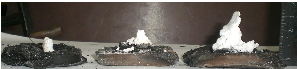
Рисунок 3.58 – Внешний вид образцов после проведения испытаний: а) контрольный, б) образец МСФ-1, в) образец МСФ/ФЭДА = 1/2
