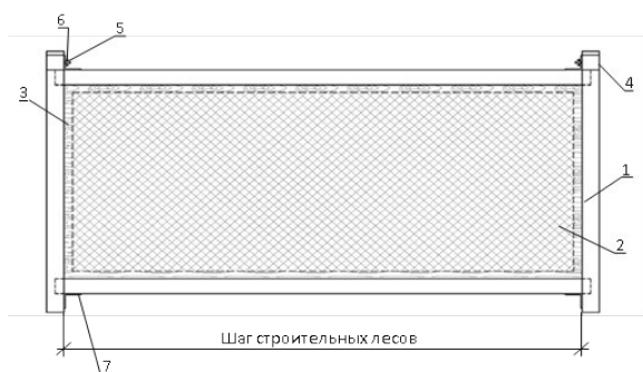
Рисунок 6 – Устройство пылезащитного экрана: 1 – станина; 2 – рогожка; 3 – штапики; 4 – хомуты; 5 – болтовые соединения; 6 – гайка; 7 – уголки.
