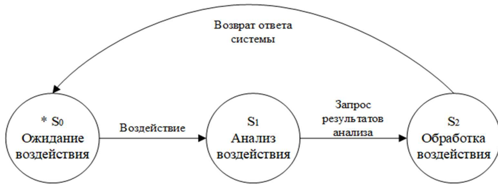
Рисунок 24 — Структура агента в виде конечного автомата, описывающего процесс имитации воздействия на ИС
