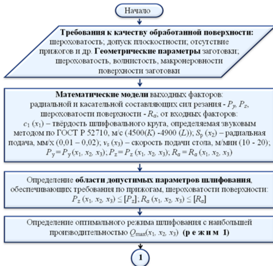
Рисунок 13 – Первый этап оптимизации режимов шлифования боковых граней заготовки исследованной направляющей малой жёсткости
