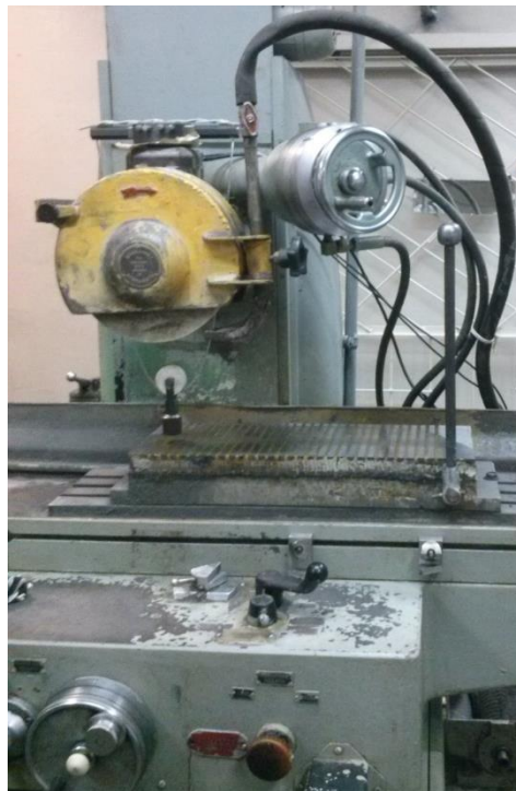
Рисунок 4.1 – Экспериментальная установка для тарировки удельного усилия притяжения магнитного поля стола станка
