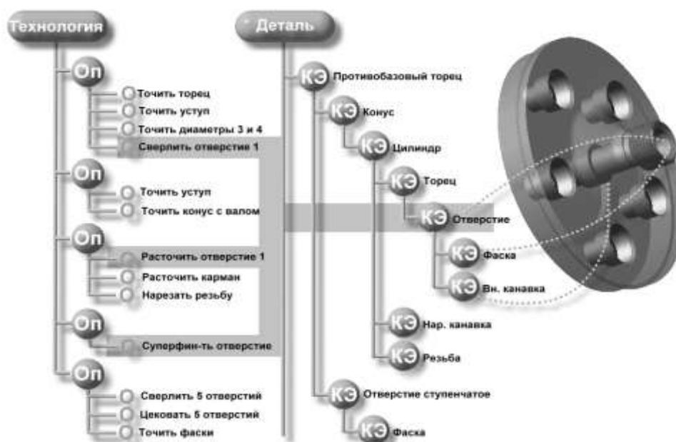
Рисунок 1.7 – Дерево конструктивных элементов объекта производства во взаимосвязи с механическими переходами технологическим процессом обработки (САПР ТП ВЕРТИКАЛЬ)
