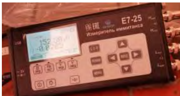
Рисунок 2.6 – Общий вид прибора для измерения электрического сопротивления условно диэлектрических материалов
