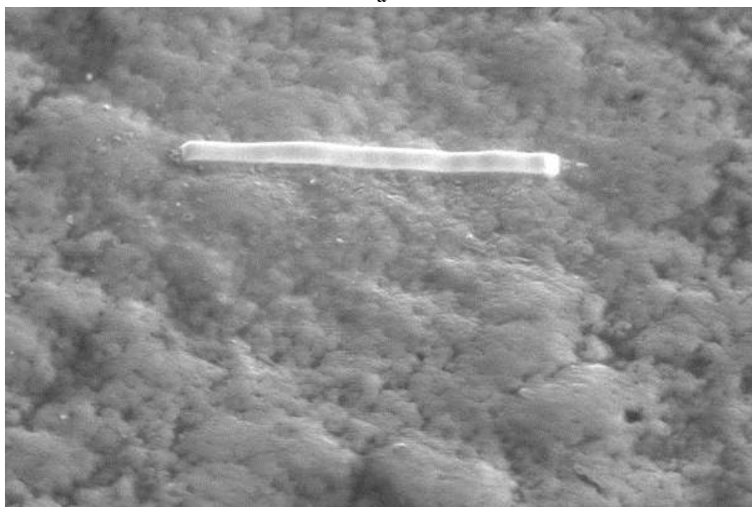
Рисунок 3.2 - Морфология поверхности сменных твердосплавных пластин с износостойким покрытием
