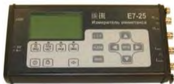
Рисунок 2.6 – Общий вид прибора для измерения электрического сопротивления условно диэлектрических материалов
