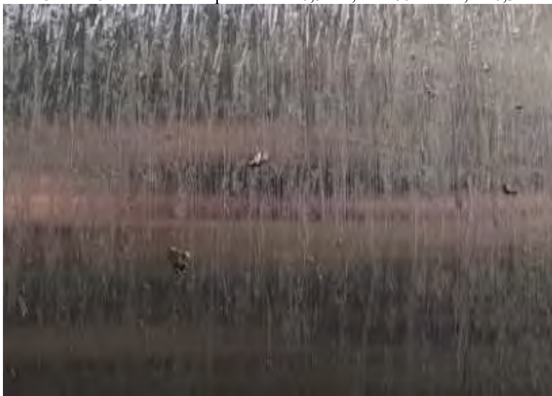
Рисунок 3.42 – Характер обработанной поверхности при обработке СМНП со значительным уровнем износа
