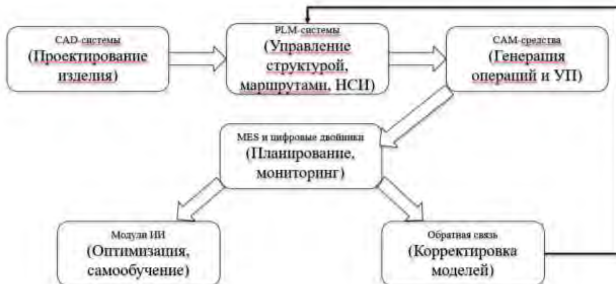
Рисунок 4.1 – Архитектура цифровой модели технологической подготовки производства (ТПП)
