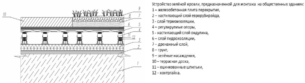
Рисунок 6.16 – Конструкция зелёной крыши для общественных зданий
