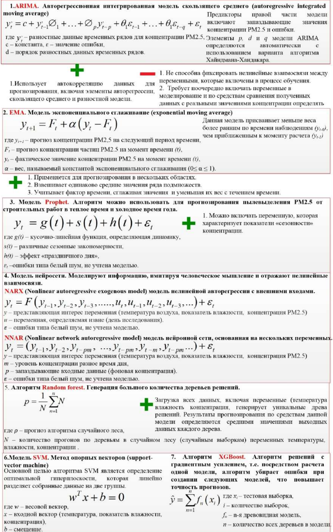
Рисунок 5.2 – Алгоритмы машинного обучения, используемые в прогнозе пылевого загрязнения в зоне влияния точечной застройки
