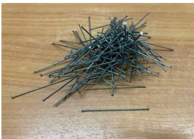
Рисунок 2.4 – Фибра «Миксарм» производства ОАО «Северсталь-метиз», согласно ТУ 1211-205-46854090-2005
