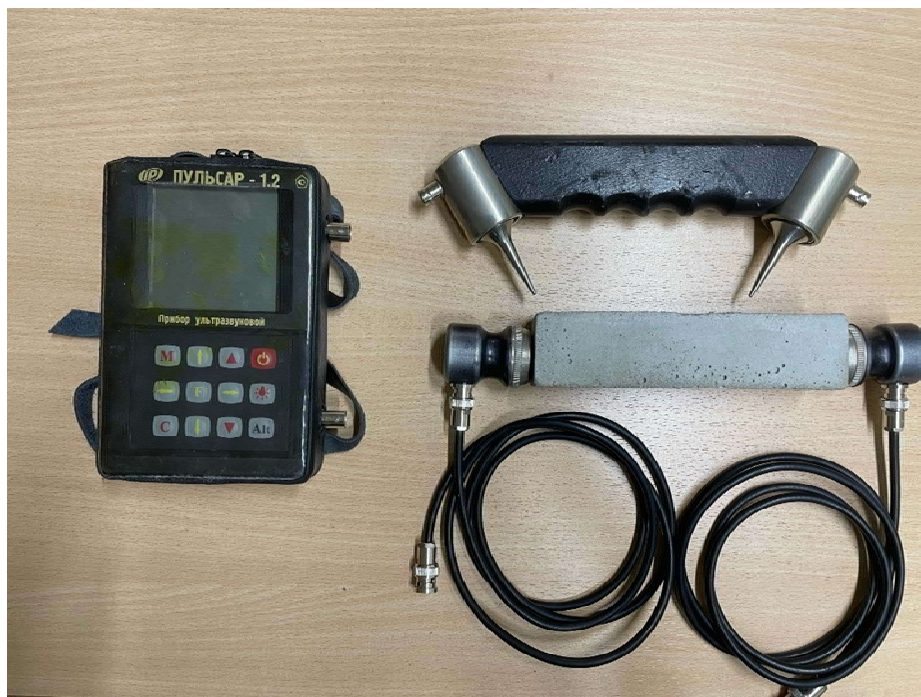
Рисунок 2.7 – Ультразвуковой прибор для неразрушающего контроля прочности бетона «Пульсар – 1.2»
