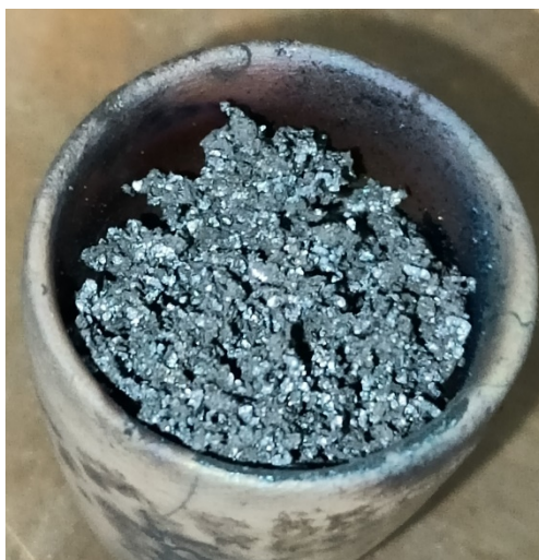
Рисунок 3.24 – Фотографии образцов ПВХ-П после пиролиза при 750 °С в течение 45 минут
