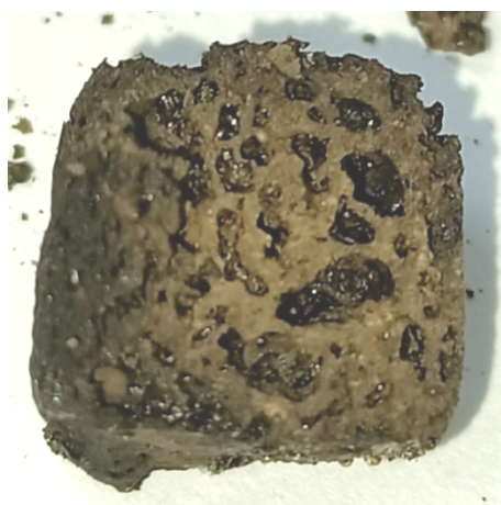
Рисунок 3.21 – Фотографии образцов ПВХ-П после пиролиза при 750 °С в течение 45 минут
