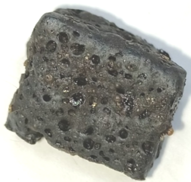
Рисунок 3.18 – Фотографии образцов ПВХ-П после пиролиза при 750 °C в течение 45 минут
