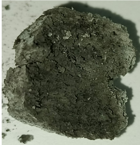
Рисунок 3.30 – Фотографии образцов ПВХ-П после пиролиза при 750 °С в течение 45 минут
