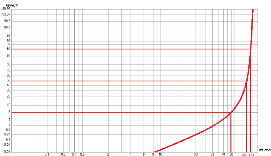
Рисунок 1 – График оседания 1 грамма пыли за 3 секунды: d_{\text{ч}} – диаметр осевших частиц; D(d_{\text{ч}}) – значение, показывающее сколько процентов от всей использованной массы пыли меньше данного диаметра
