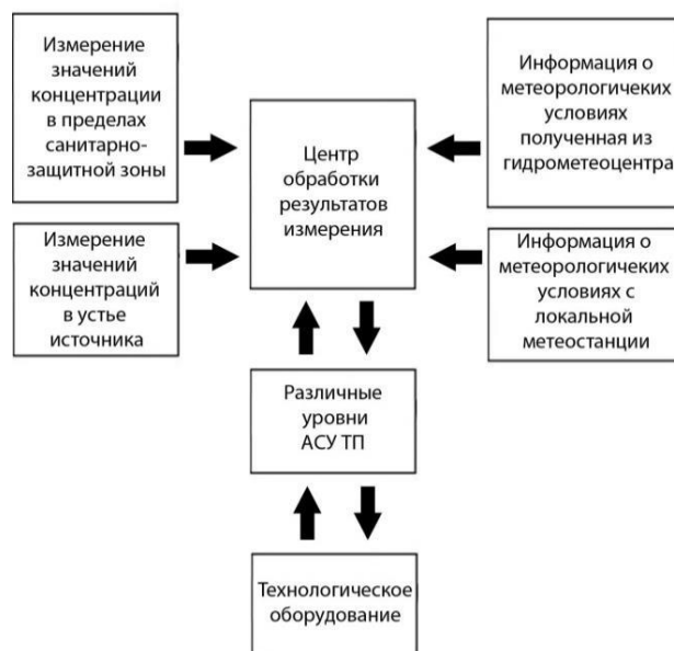
Рисунок 1 – Принципиальная блок-схема, отображающая основные компоненты системы контроля выбросов на предприятии и условия производственного процесса
