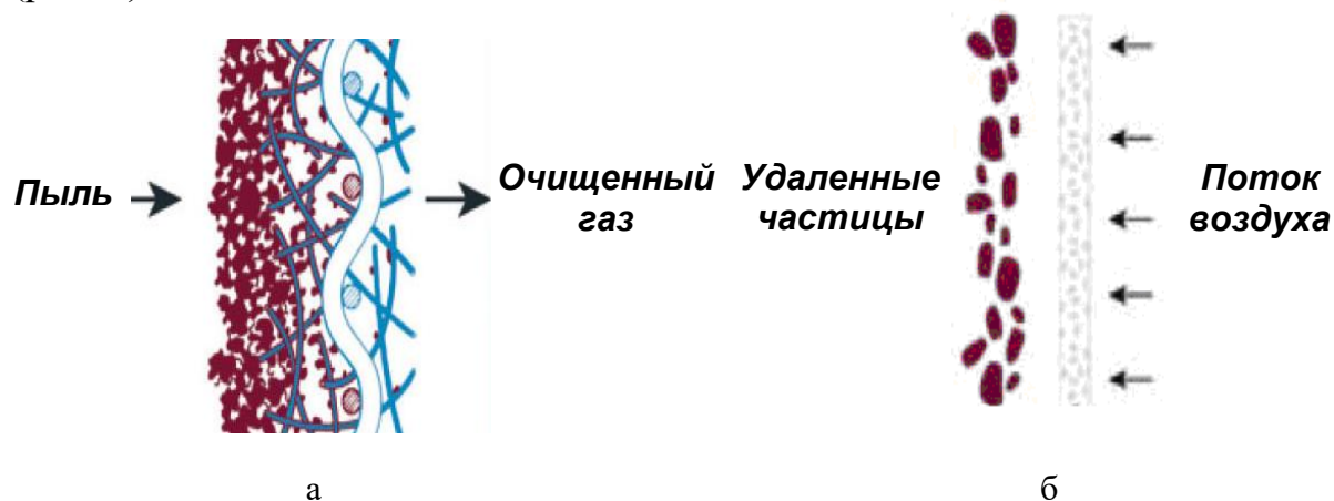
Рисунок 1 – Отложение пыли на поверхности ткани: а – фильтрация; б – очистка (регенерация)
