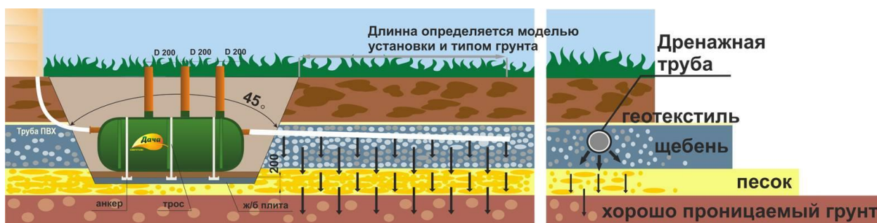
Рис. 1 Фильтрация воды при помощи грунта
