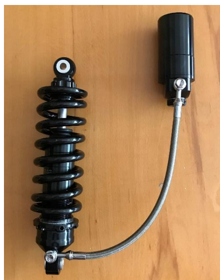
Рис. 1. Регулируемый гидроамортизатор с выносной компенсационной камерой
