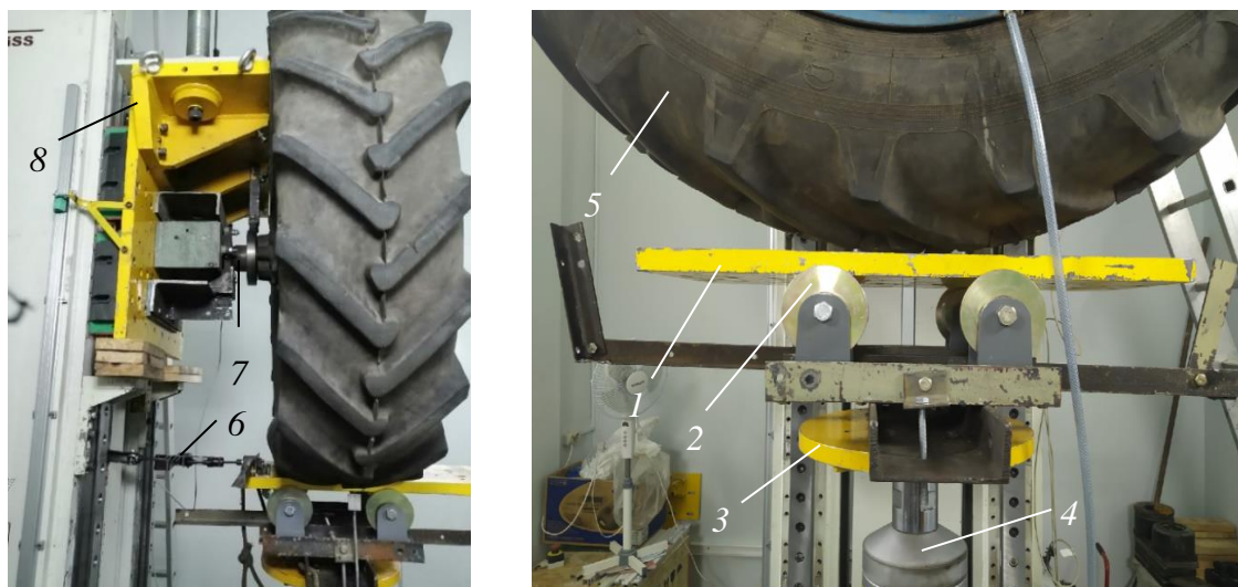
Рис. 1. Универсальная экспериментальная установка для измерения боковой жесткости (а) и силы сопротивления качению колеса (б): 1 – подвижная опорная плита; 2 – ролики с ребордами; 3 – опорный диск гидропульсатора; 4 – датчик силы; 5 – испытуемое колесо; 6 – динамометр Токаря; 7 – ось колеса; 8 – подвижная траверса с грузами
