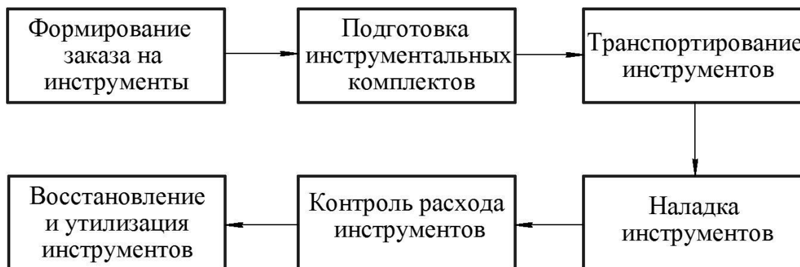
Рис. 1. Схема системы инструментального обеспечения
