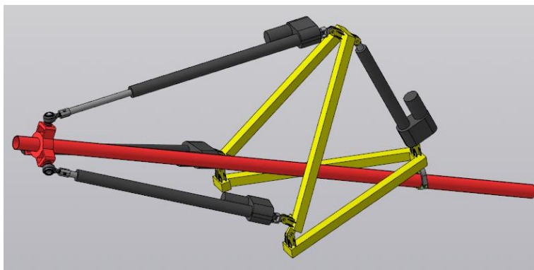
Рис. 1. 3D модель манипулятора параллельно-последовательной структуры
