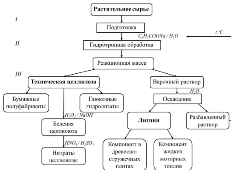
Рис. 1. Комплексная схема переработки растительного сырья недревесного происхождения
