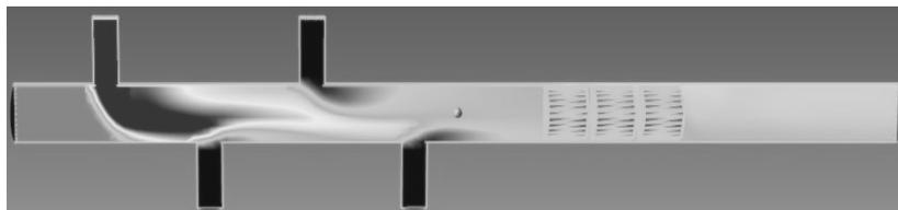
Рис. 2. Распределения концентрации толуола по сечению трубы с применением 3 гофрированных насадок
