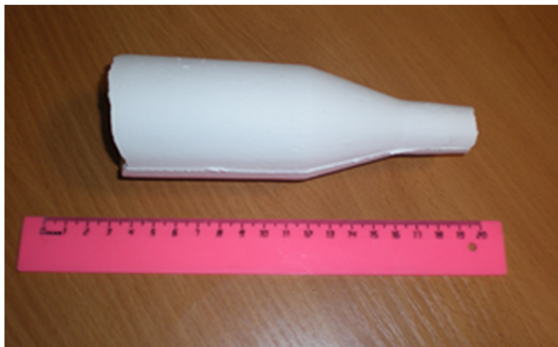
Рис. 2. Экспериментальные образцы керамических контейнеров с покрытиями на основе тетраэтоксисилана
