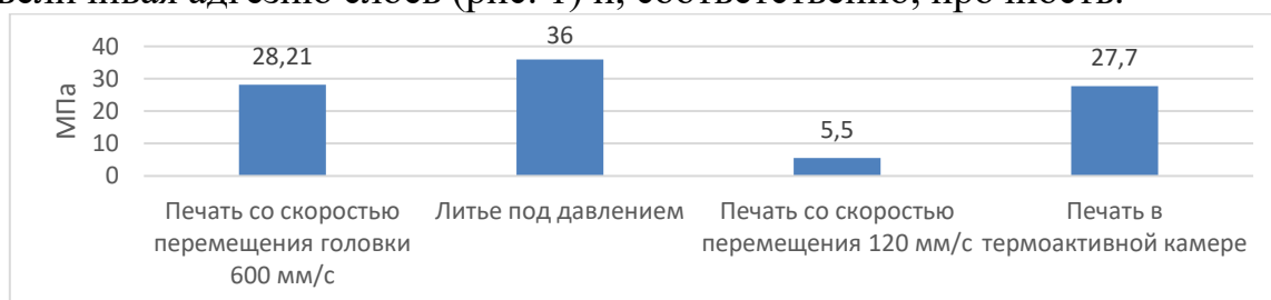
Рис. 1 – Условная прочность на разрыв образцов из акрилонитрил-бутадиен-стирола в зависимости от технологических факторов 3D-печати
