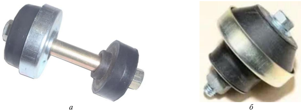
Рис. 8. Передняя (а) и задняя (б) опоры кабины автомобиля ГАЗ-3307в сборе
