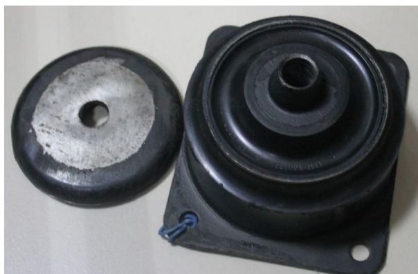
Рис. 6. Резинометаллический амортизатор системы поддрессирования кабины автомобиля ЗИЛ-5301
