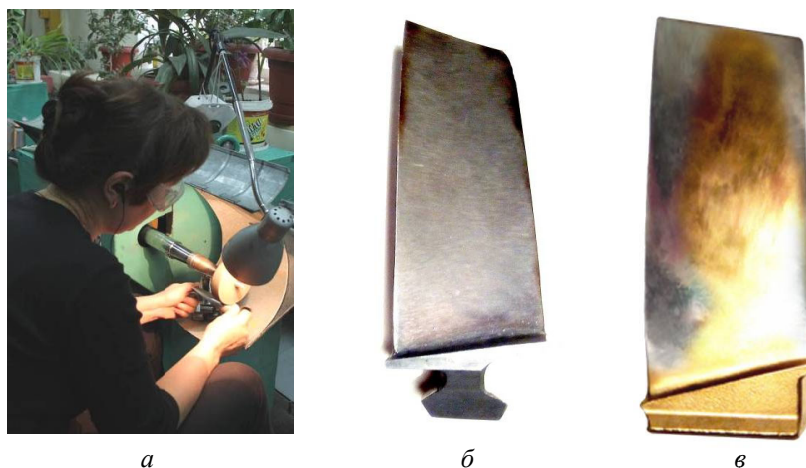
Рис. 3. Обработка лопаток в процессе их ремонта
