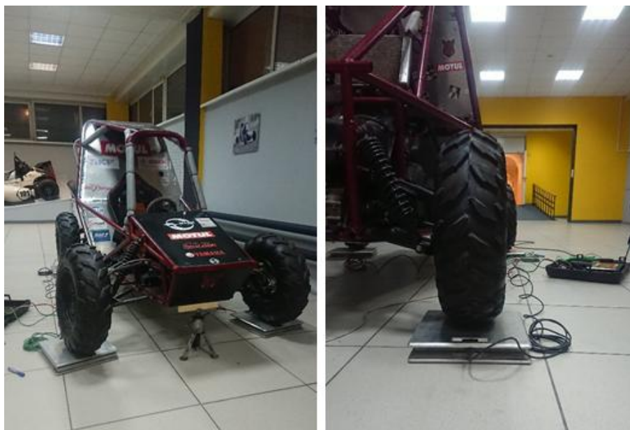
Рис. 5. Взвешивание болида BAJA SAE
