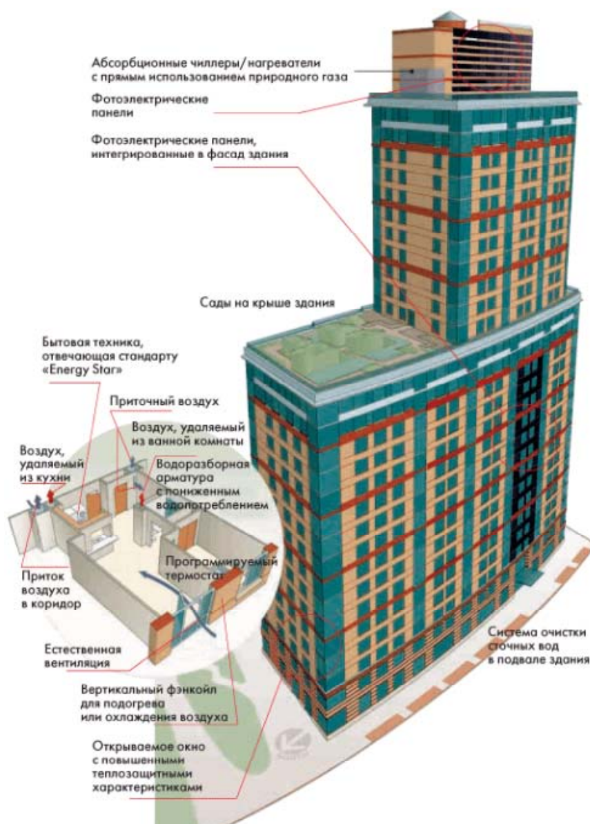
Рис. 1. Общий вид «Здания двадцати террас» и применяемых в нем технологий
