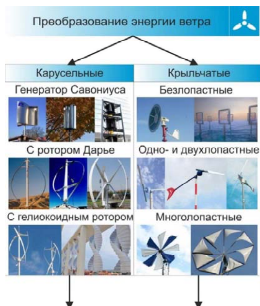
Рис. 3. Типы ветрогенераторов и проекты высотных зданий с их применением
