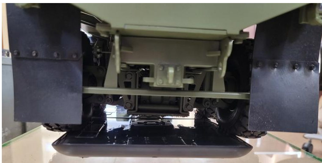
Рис. 5. Установка колесной оси на измерительных весах
