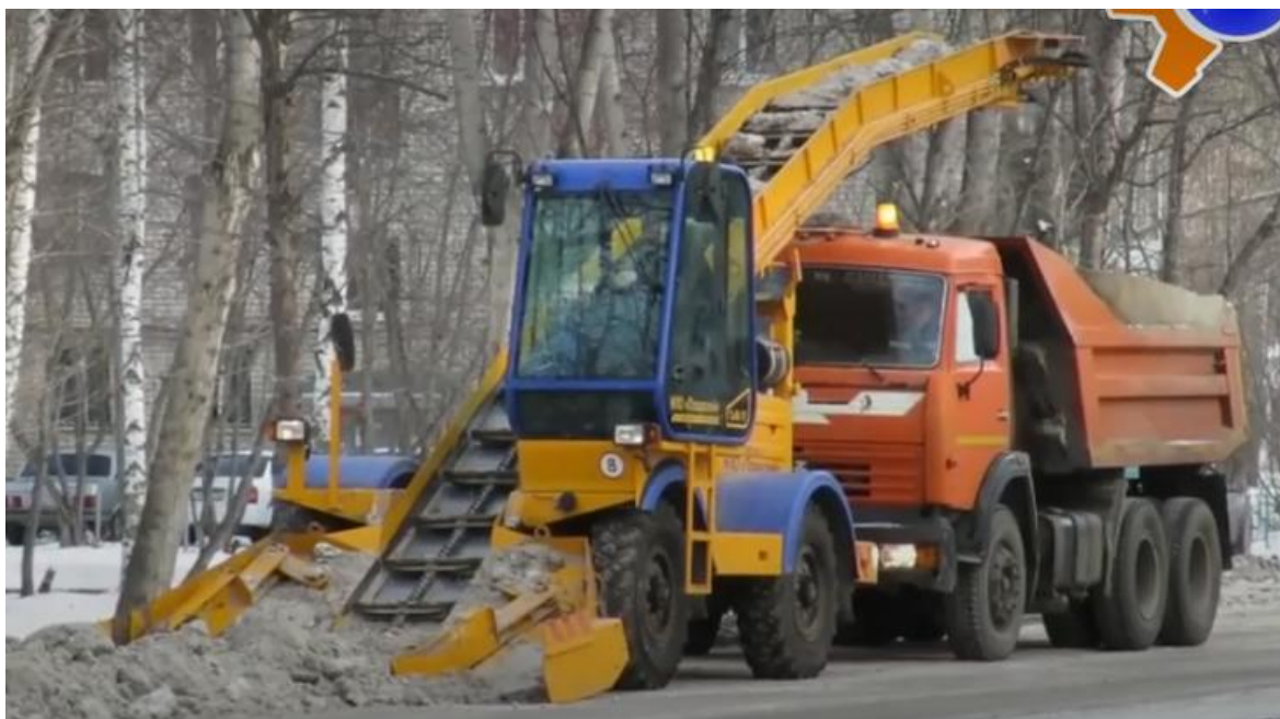
Рис. 1. Снегопогрузчик лаповый СнП-17 загружает снег в самосвал
