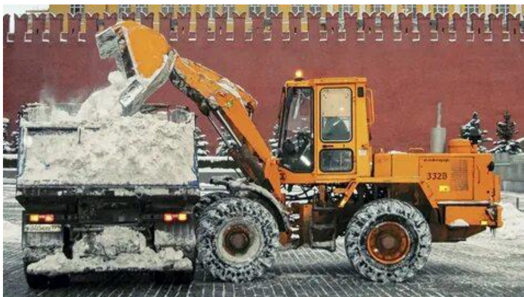
Рис. 3. Фронтальный погрузчик «Амкодор 332В» с ковшом вместимостью 2,9 \text{ м}^3 (увеличенный) и мощностью 96,5 кВт
