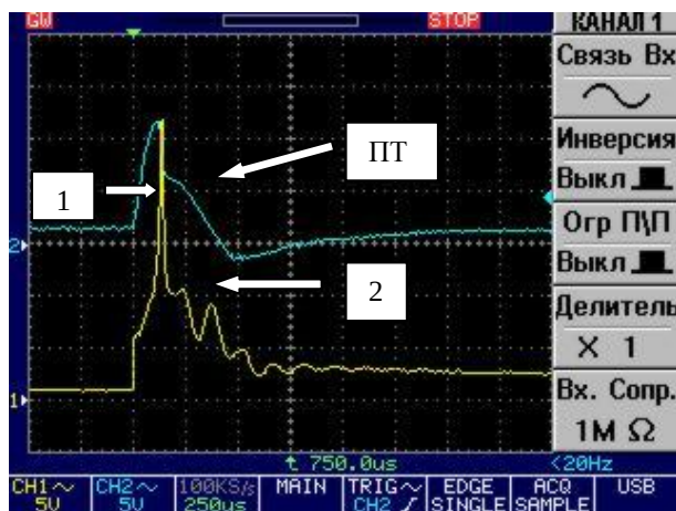
Рис. 1. Характерные осциллограммы разрядного тока – 1 и напряжения – 2 согласованного режима электрического взрыва алюминиевого (Al) проводника. Диаметр d_{\text{созл}} = 1,23 \text{ мм} , длина \ell_{\text{созл}} = 220 \text{ мм} , начальное напряжение U_0 = 2,6 \text{ кВ} . ПТ – пауза тока
