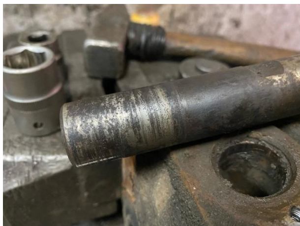
Рис. 1. Шкворень со следами износа
