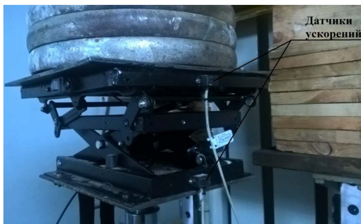
Рис. 2. Расположение датчиков ускорений на экспериментальной установке
