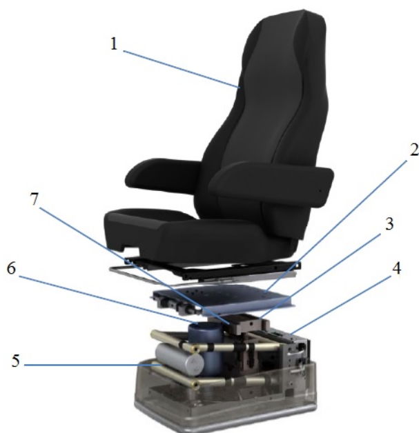
Рис. 9. Система «Bose Ride»: 1 – верхняя часть сиденья; 2 – двенаправленное горизонтальное поддрессирование; 3 – линейный электромагнитный привод; 4 – рекуперативный усилитель с блоком управления; 5 – направляющий механизм; 6 – пневматический элемент; 7 – интеллектуальный датчик
