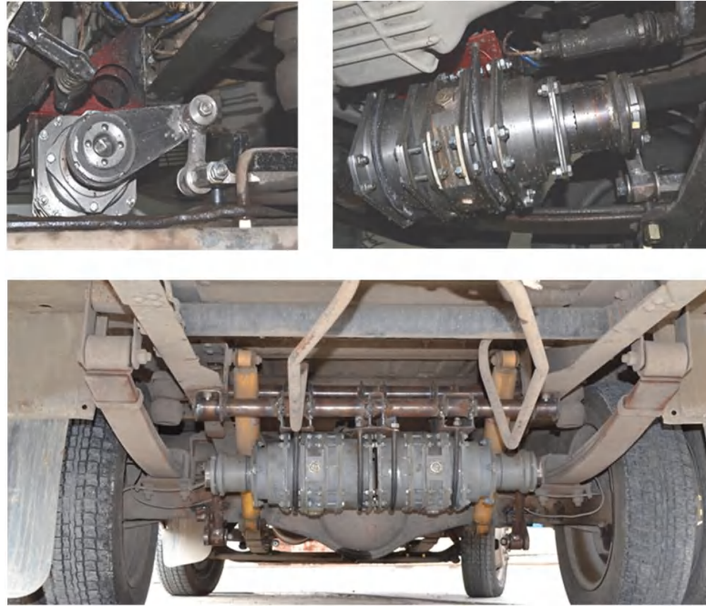
Рис. 1. Установка экспериментального ИФА на автомобиль «ГАЗель» на передней подвеске (виды спереди и сбоку) и на задней подвеске
