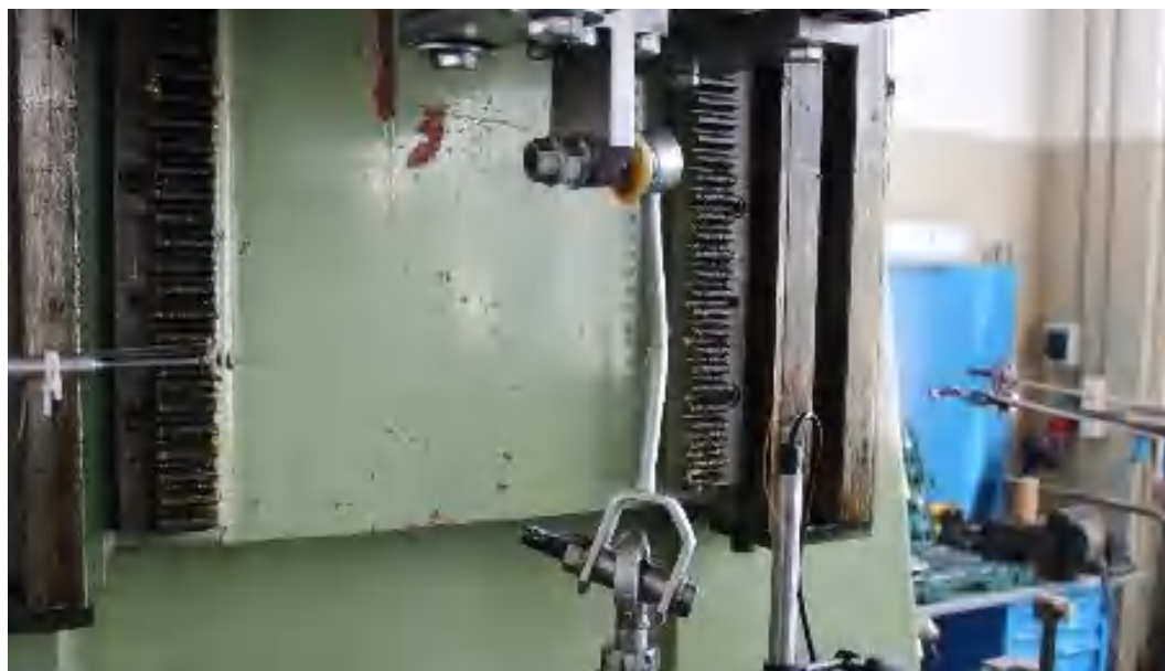
Рис. 12. Шарнирная тяга подвески после потери устойчивости
