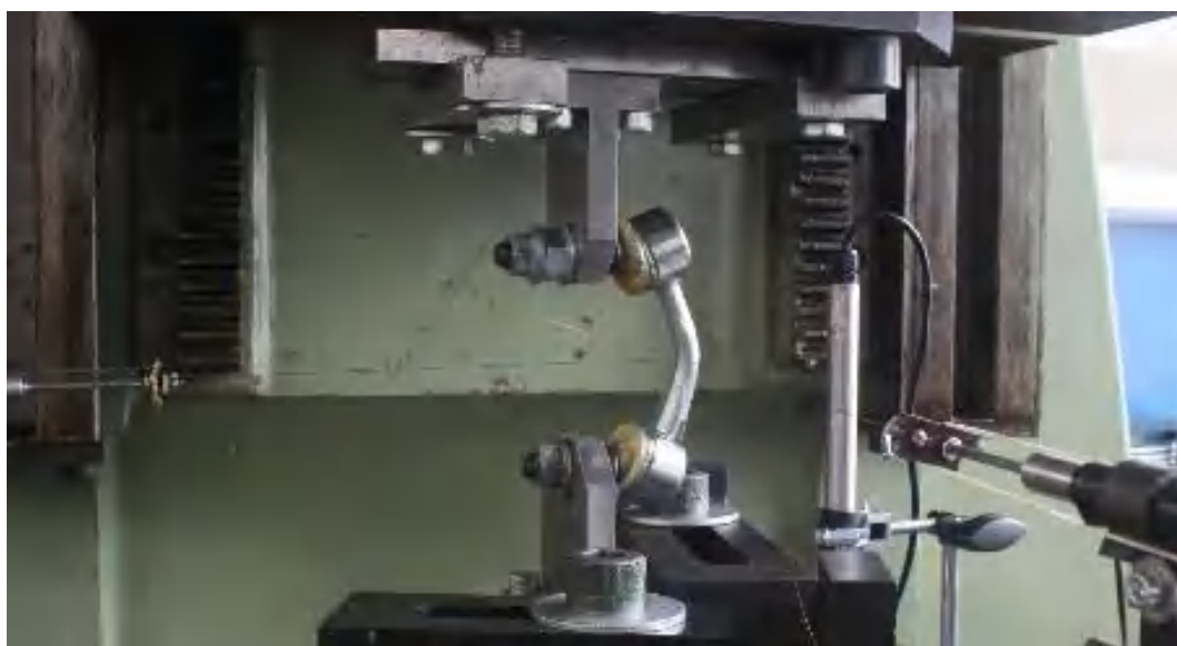
Рис. 11. Стойка заднего стабилизатора после потери устойчивости
