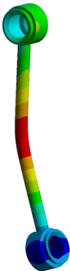
Рис. 4. Суммарные перемещения в стойке переднего стабилизатора после потери устойчивости
