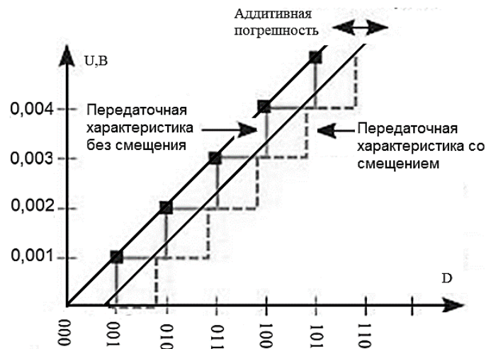
Рис. 4. Аддитивная погрешность ЦАП
