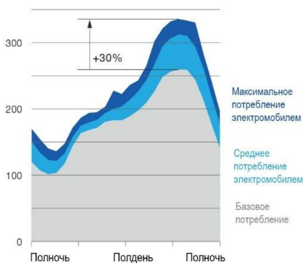
Рис. 2. Нагрузка на электросеть для 150 домов с двумя автомобилями на дом и 25 %-м проникновением электромобилей (кВт)
