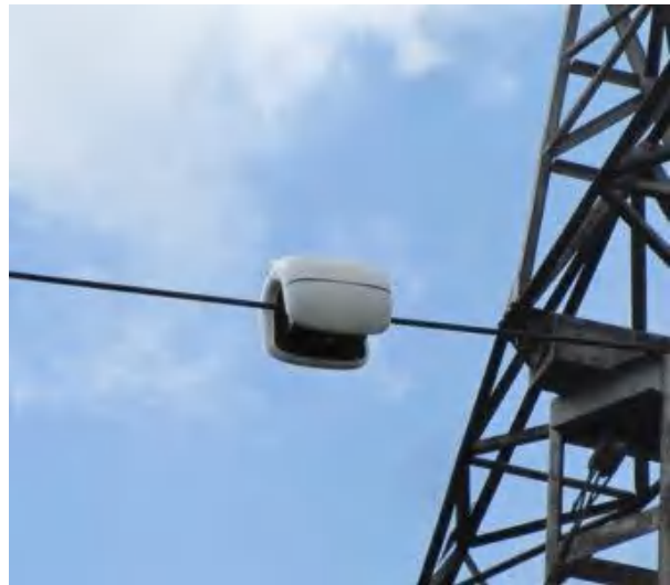
Рис. 1. Измерительная сфера Gridpulse компании OTLM-device (Словения)
