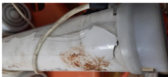
Рис. 1. Разбитый рециркулятор ОБР-1 после падения в результате поломки крепежей от чрезмерной вибрации
