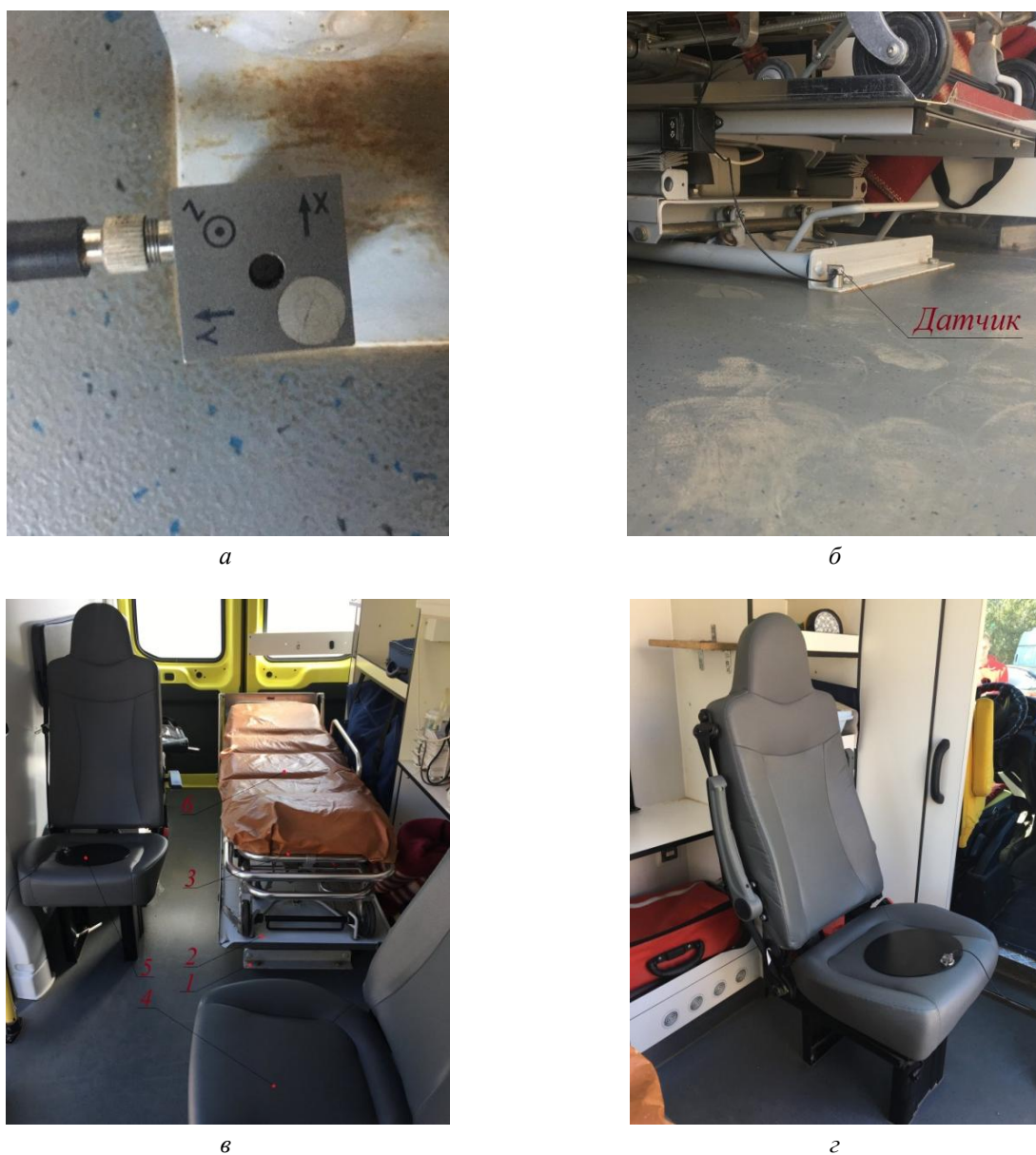
Рис. 5. Расположение контрольных точек замера ускорений датчиком:
